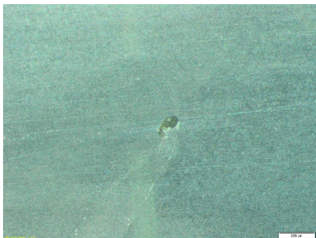
Slika 36. Plinski mjehurić-pora kuglastog oblika
