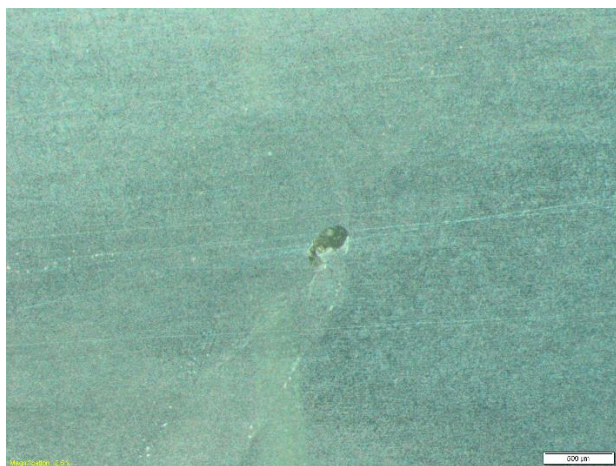
Slika 36. Plinski mjehurić-pora kuglastog oblika
