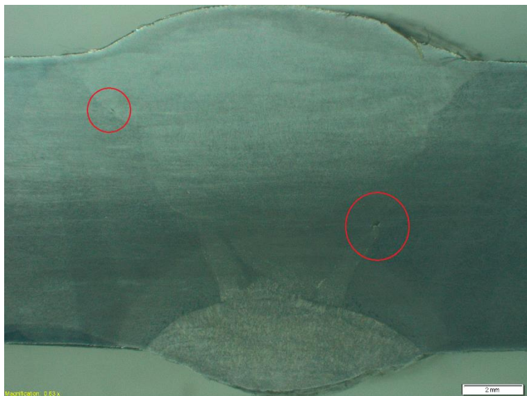
Slika 35. Pogreške u sučeljenom spoju
