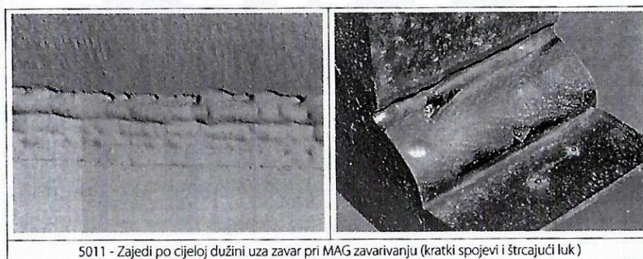
Slika 20. Pogreške oblika zavara-zajedi
