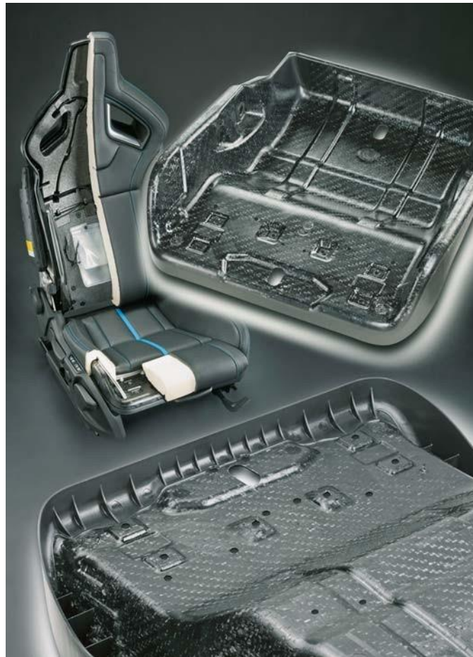
Slika 15. Primjer školjke sjedala od staklenih vlakana
