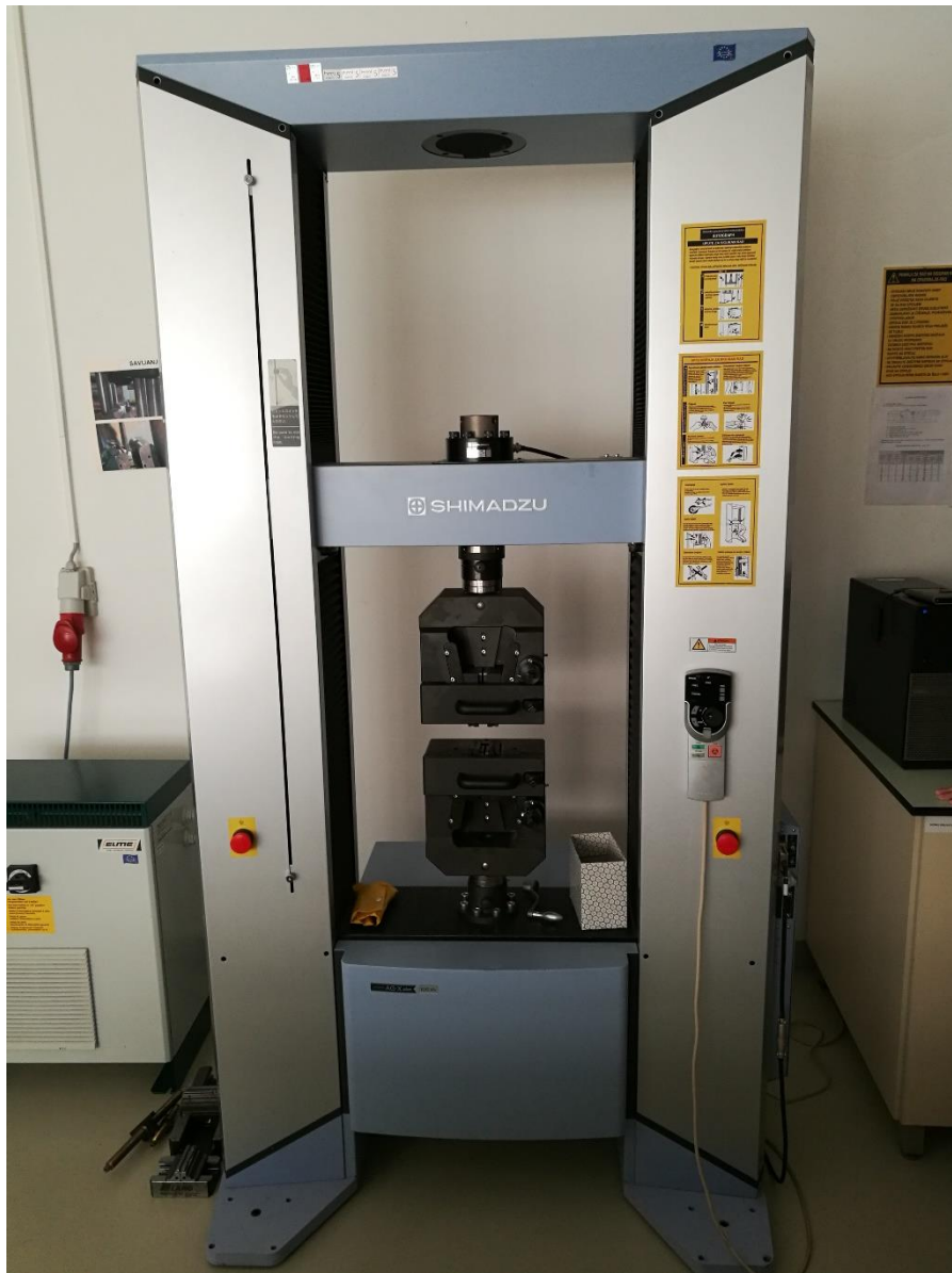
Slika 19. Kidalica SHIMADZU AG-X
