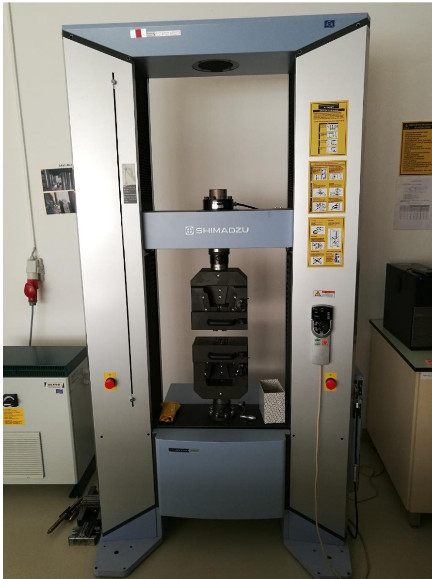
Slika 19. Kidalica SHIMADZU AG-X
