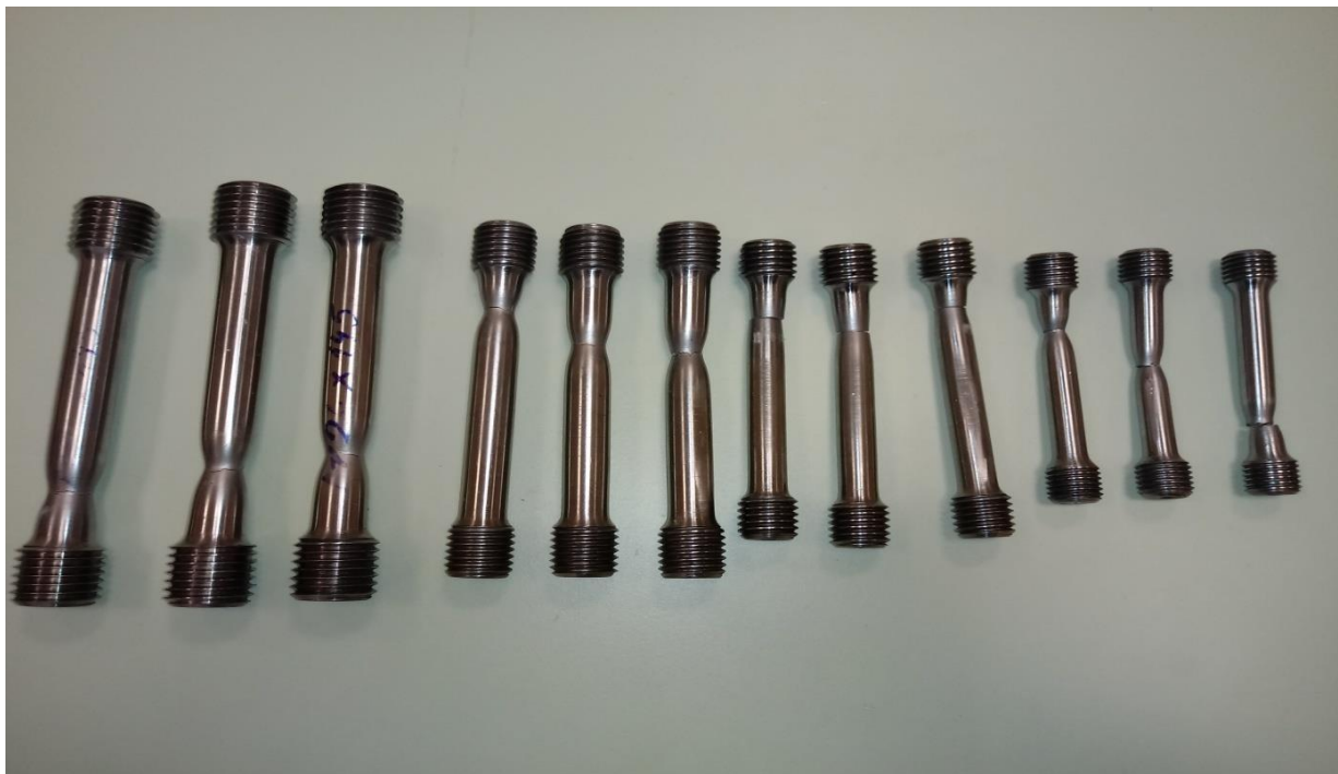
Slika 20. Pokidane epruvete koje su korištene u ovome radu
