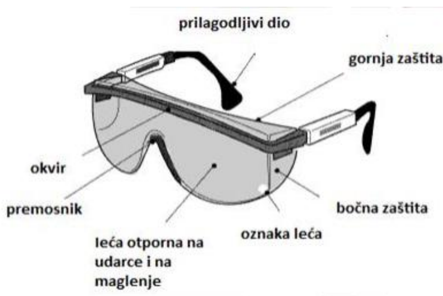
Slika 5: Dijelovi zaštitnih naočala [2]
