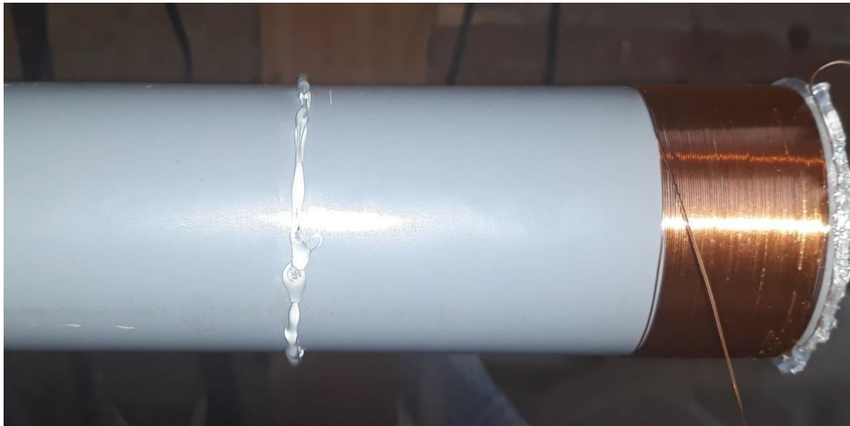
Slika 32. Fotografija izrade zavojnice. Izvorno autor.
