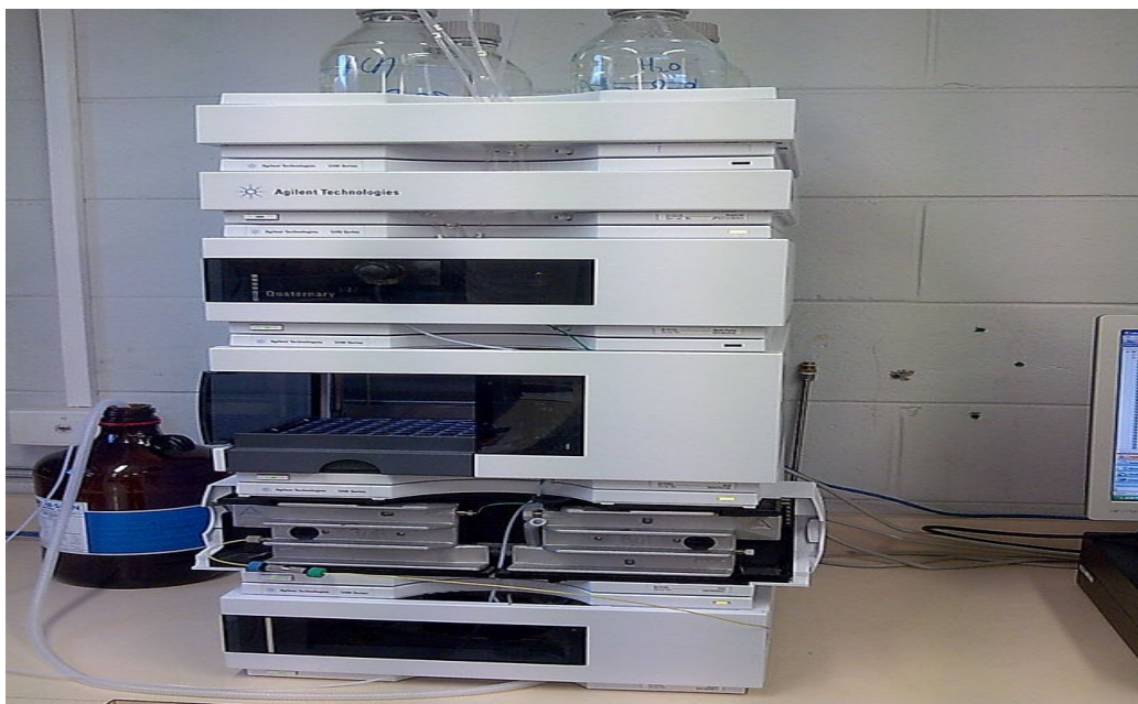
Slika 10. Suvremeni uređaj za tekućinsku kromatografiju visoke djelotvornosti
