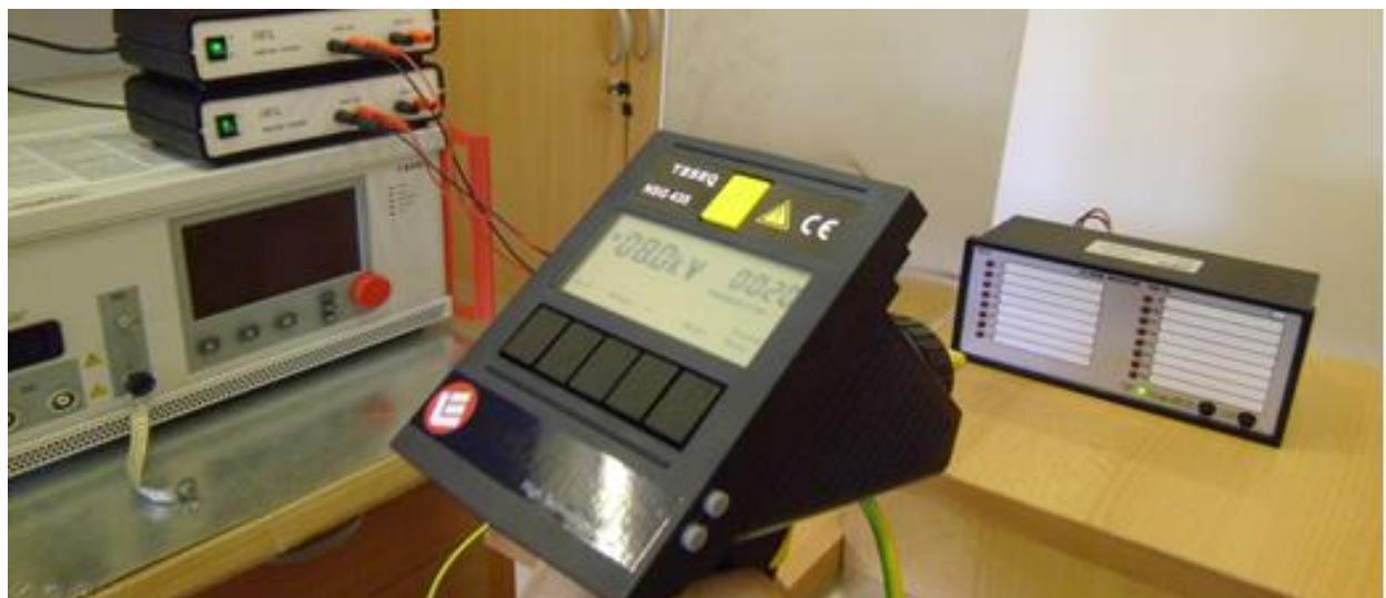
Slika 6. Predodžba EMC ispitivanja otpornosti na elektronsko pražnjenje [28].
