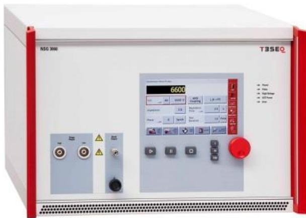
Slika 16. Predodžba uređaja NSG3060 za EMC testiranje [37].
