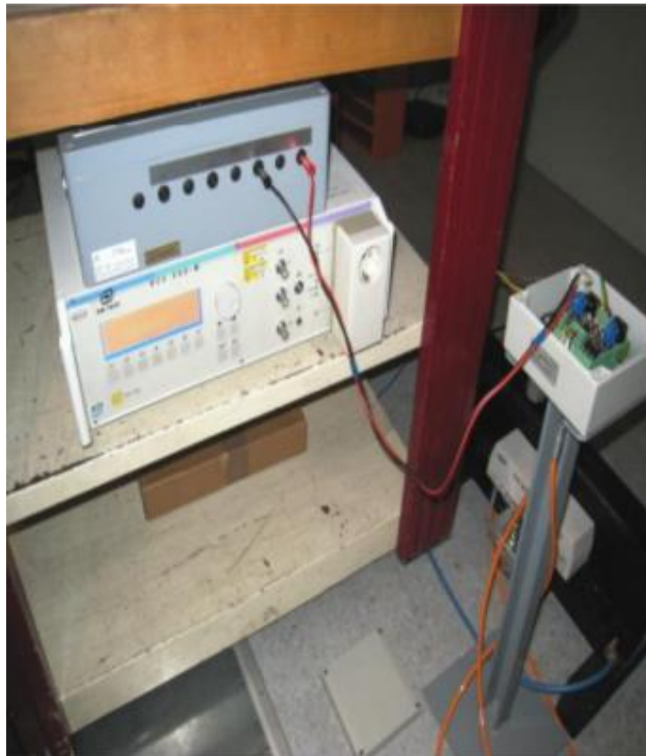
Slika 12. Predodžba ispitivanja otpornosti na udarne prenapone [34].
