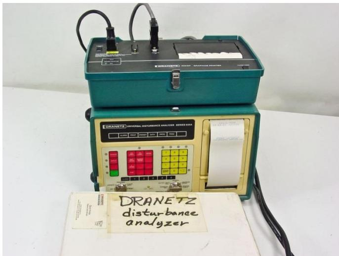
Slika 15. Predodžba uređaja Dranetz 626A [36].
