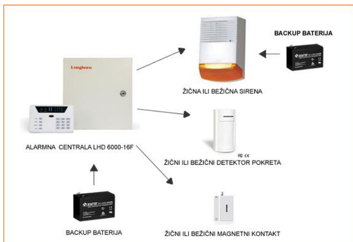
Slika 1. Predodžba alarmnih sustava [23].
