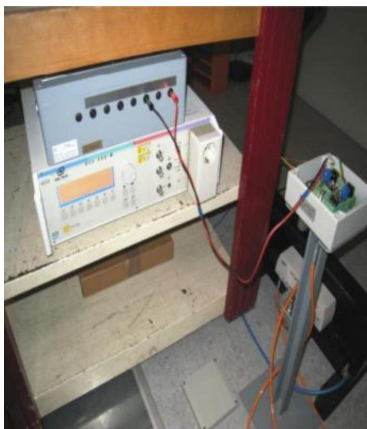
Slika 12. Predodžba ispitivanja otpornosti na udarne prenapone [34].
