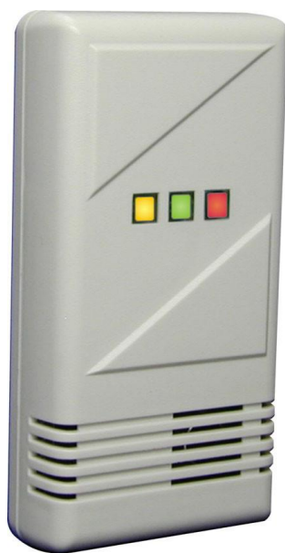
Slika 3. Predložba detektora loma stakla [25].
