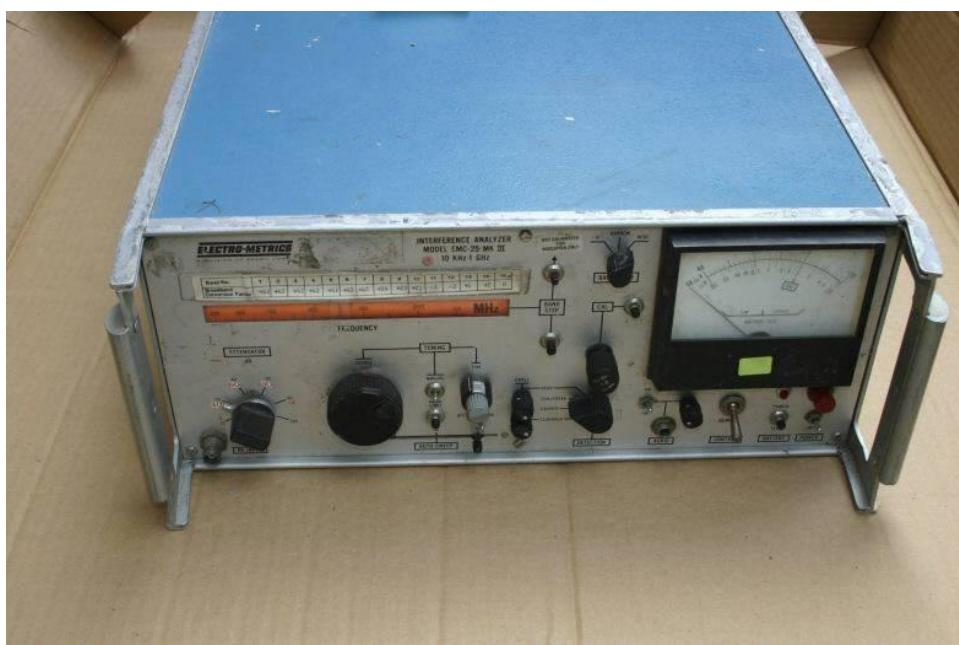
Slika 14. Predodžba uređaja Electrometrics EMC 25 MKIII [35].
