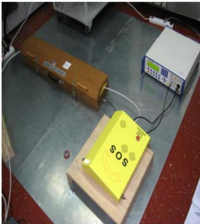
Slika 11. Predodžba ispitivanja otpornosti na brze tranzijante [33].
