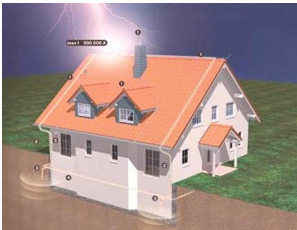
Slika 8. Predodžba vanjskog sustava za zaštitu od udara munje [30].
