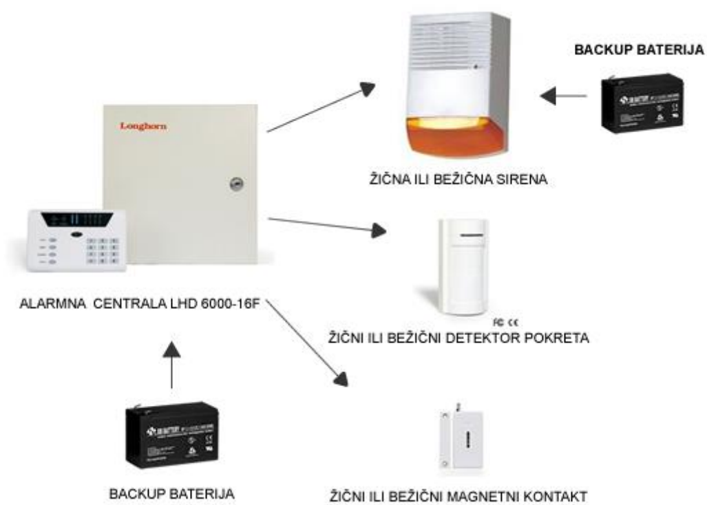
Slika 10: Predodžba alarmne centrala i elemenata [26]
