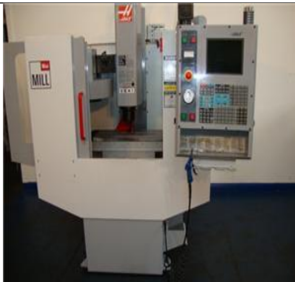
OBRADNI CENTAR HASS MINIMILL
