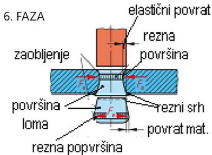
Slika 8. Šesta faza toka rezanja [3]
