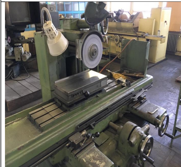
BRUSILICA ZA OBODNO BRUŠENJE
