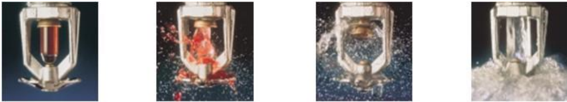
Slika 13. Prikaz aktiviranja mlaznice s ampulom [ 11 ]
