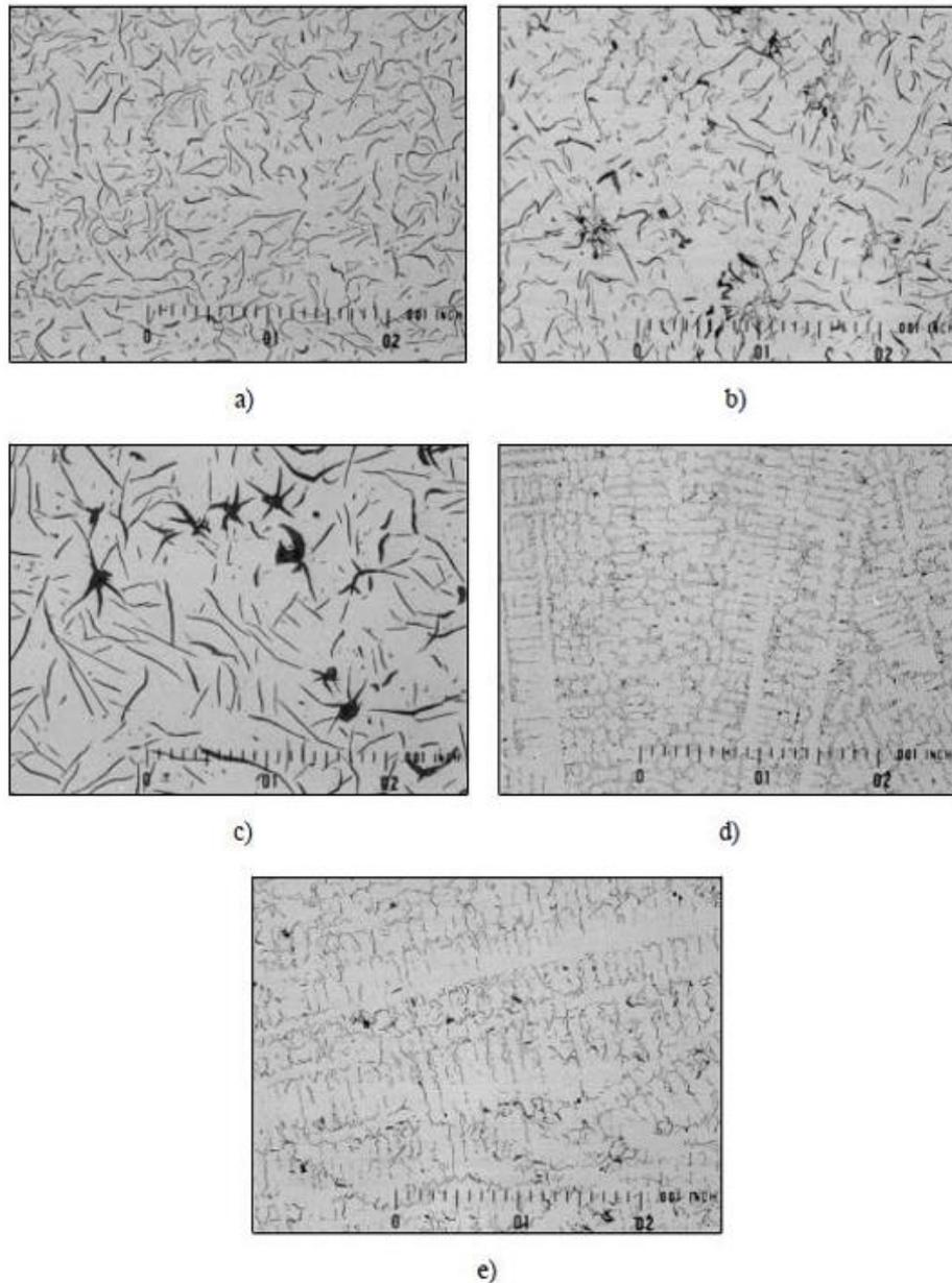
Slika 7. Tipovi listićavog grafitu prema ASTM A 247: a) tip A, b) tip B, c) tip C, d) tip D, e) tip E [5]
