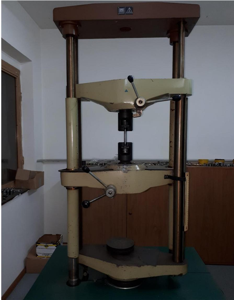
*Slika 12. Kidalica za statički vlačni pokus*
