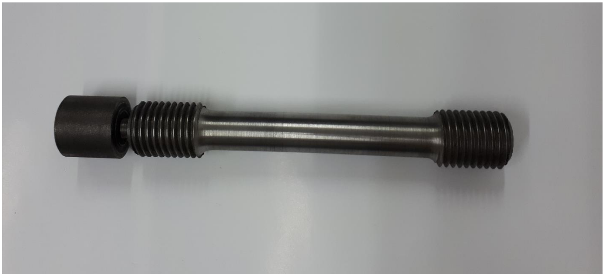
Slika 11. Epruveta sa dodatkom SL20 prije statičkog vlačnog ispitivanja
