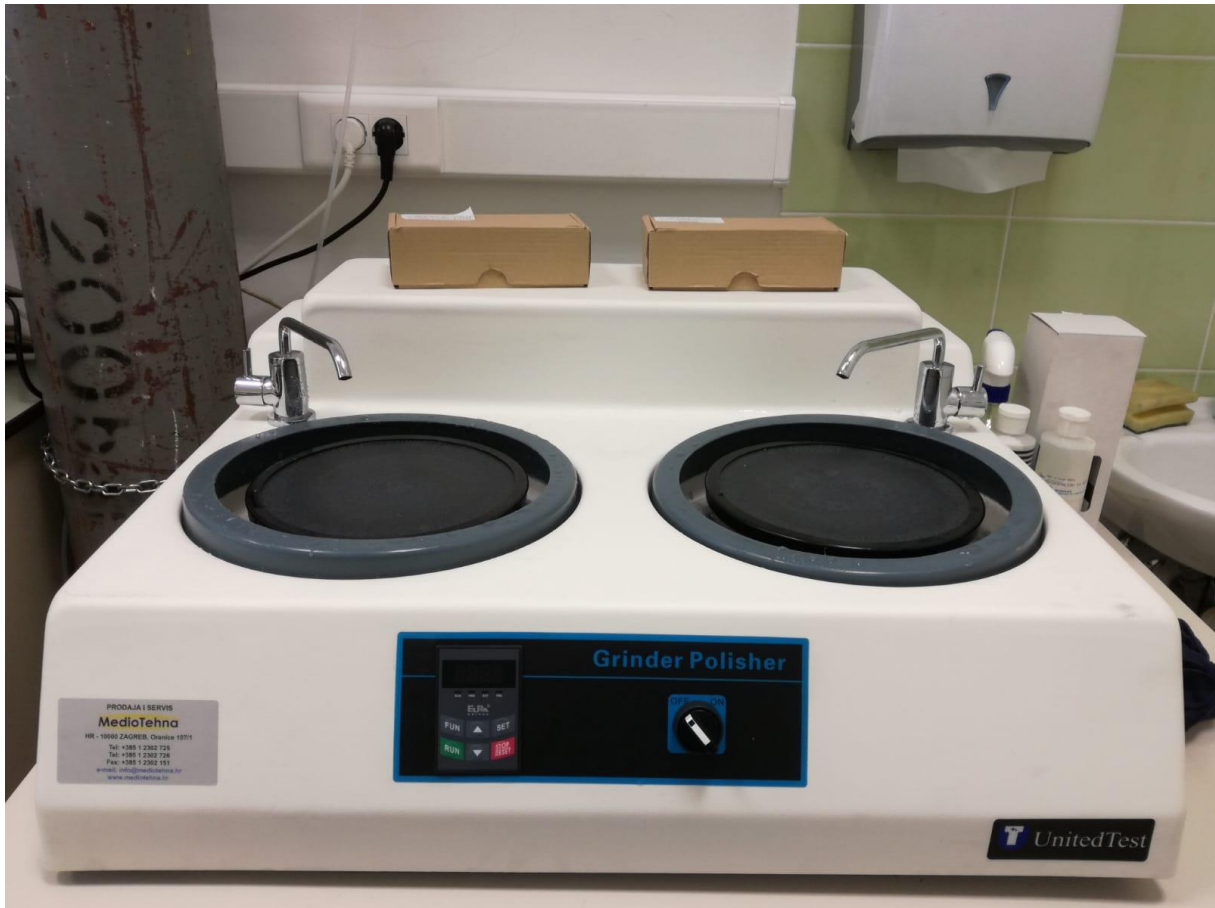
Slika 17. Uređaj za brušenje i poliranje
