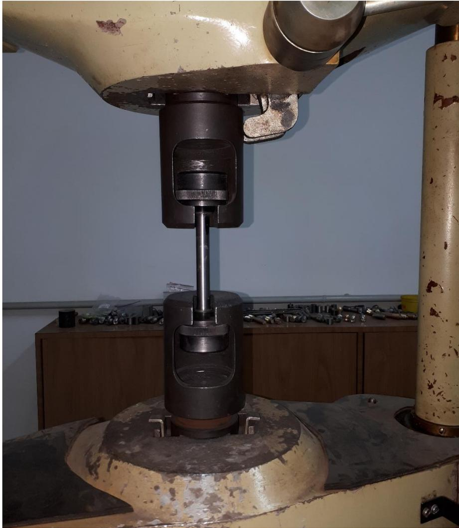
*Slika 13. Učvršćena epruveta*
