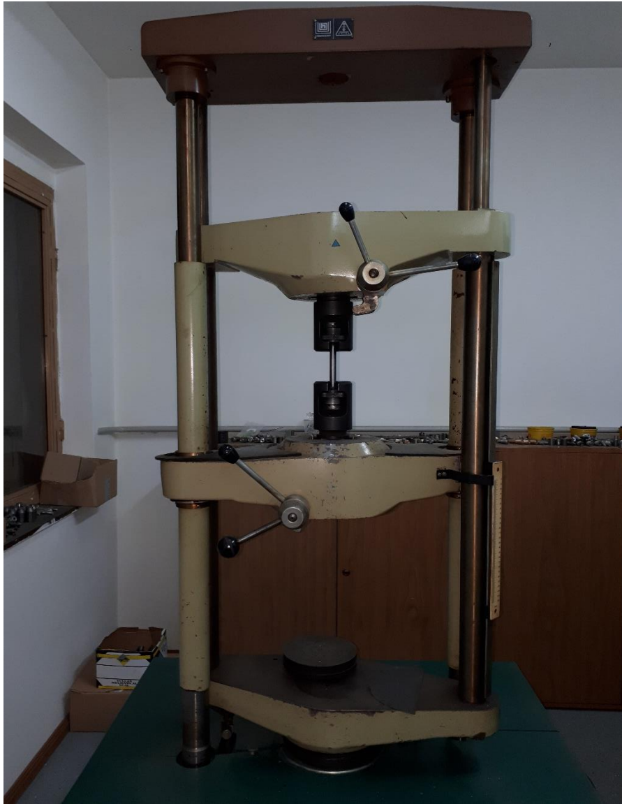
Slika 12. Kidalica za statički vlačni pokus
