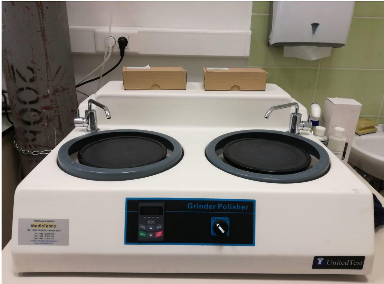
Slika 17. Uređaj za brušenje i poliranje
