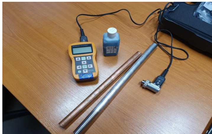
Slika 11. Uređaj za ispitivanje debljine stijenke ultrazvukom
