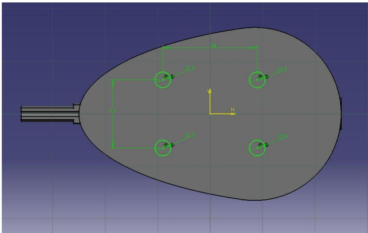
Slika 41. Dimenzije provrta za pričvršćivanje olovnog utega
