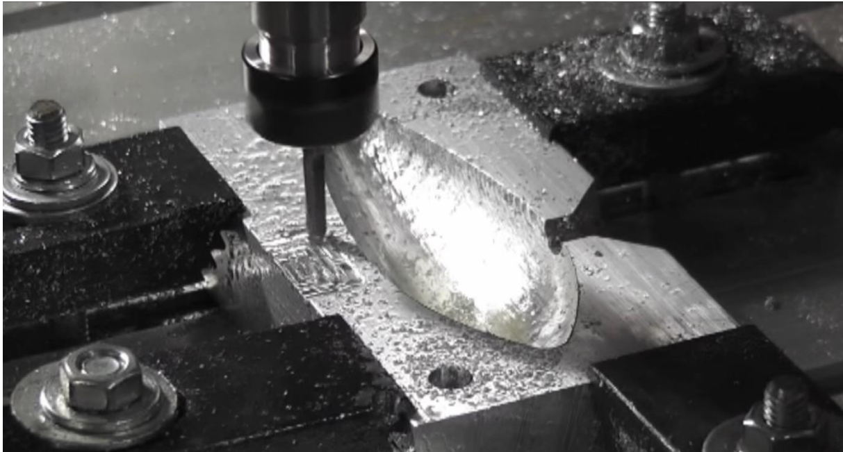
Slika 16. Aluminijski kalup na CNC stroju [12]
