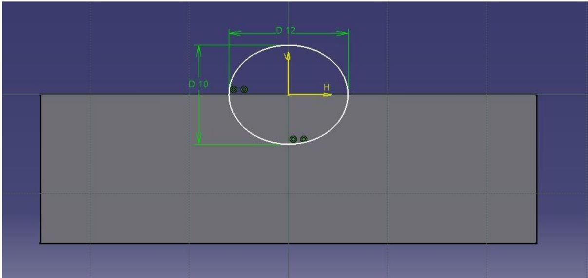
Slika 35. Ulijevni otvor 1
