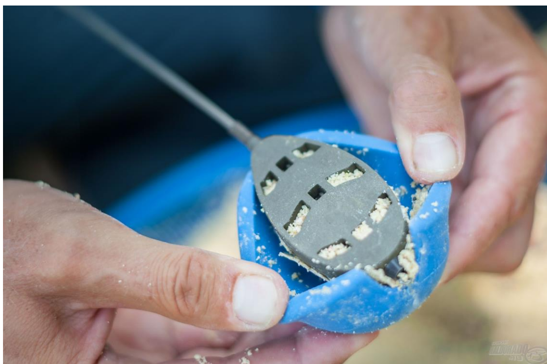
Slika 10. Vađenje hranilice iz kalupa [16]
