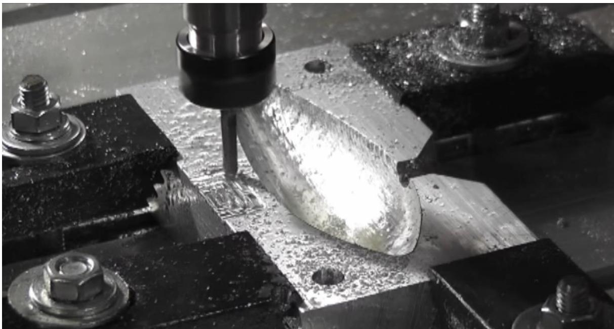
Slika 16. Aluminijski kalup na CNC stroju [12]
