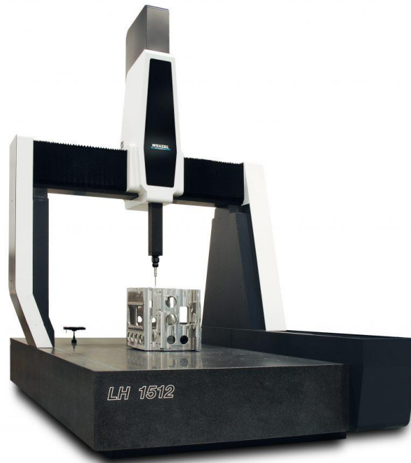
Slika 3. Primjer aktivne mjerne metode – Wenzel CMM [6]
