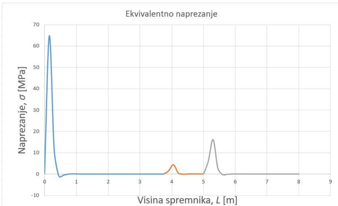
Slika 22. Predodžba ekvivalentnog naprezanje. Izvorno autor.
