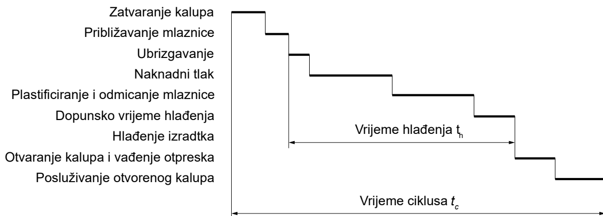
Slika 4. Faze ciklusa injekcijskog prešanja [2]
