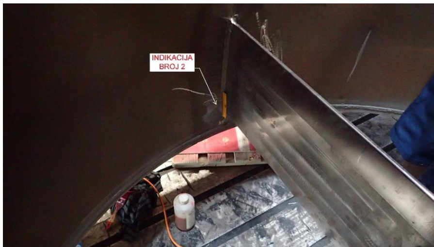
Slika 38. položaj indikacije broj 2 na nosaču glavine. [2]
