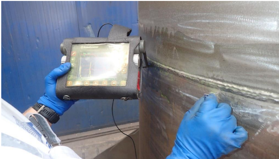
Slika 53. Ultrazvučno ispitivanje kružnog tehnološkog zavora plašta izlazne cijevi. [2]
