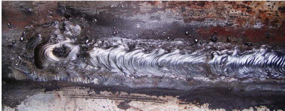
Slika 21. Primjer onečišćenja zavara kapljicama materijala. [2]
