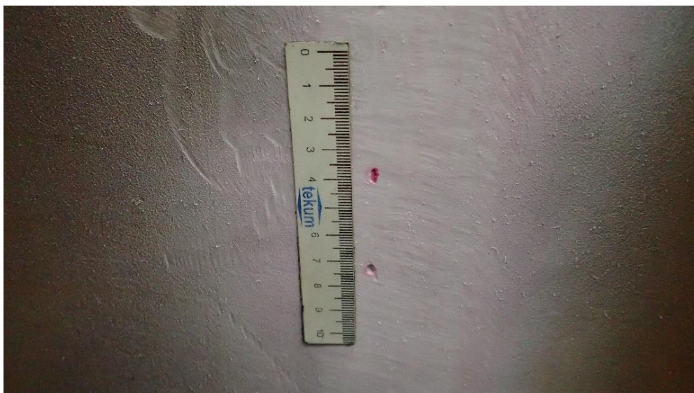
Slika 48. Detalj indikacije broj 2, dužine 6mm. [2]
