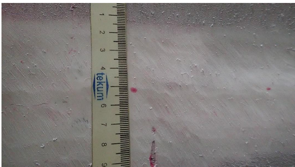
Slika 46. Detalj indikacije broj 1, dužine 4mm. [2]
