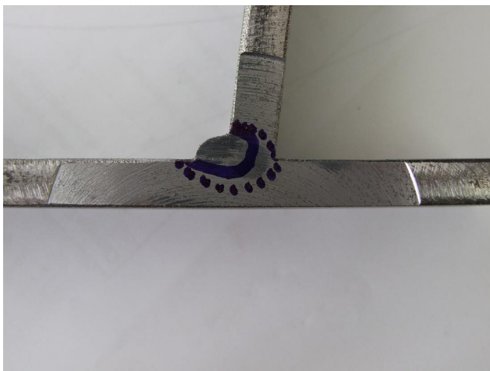
Slika 6.4 Presjek zavora ispitnog uzorka
