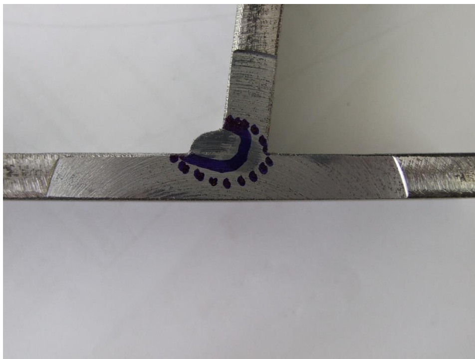
Slika 6.4 Presjek zavora ispitnog uzorka
