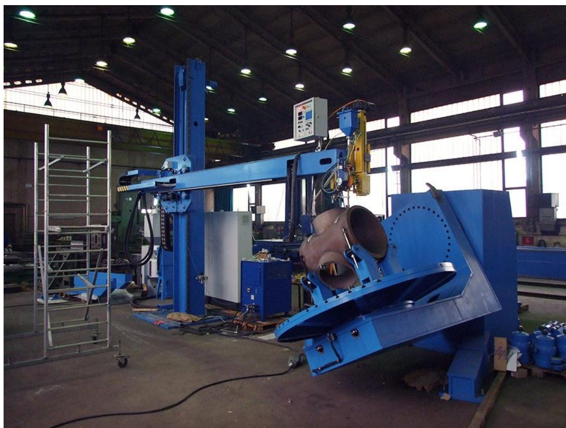
Slika 1.3 Stup za zavarivanje i pozicioner [4]
