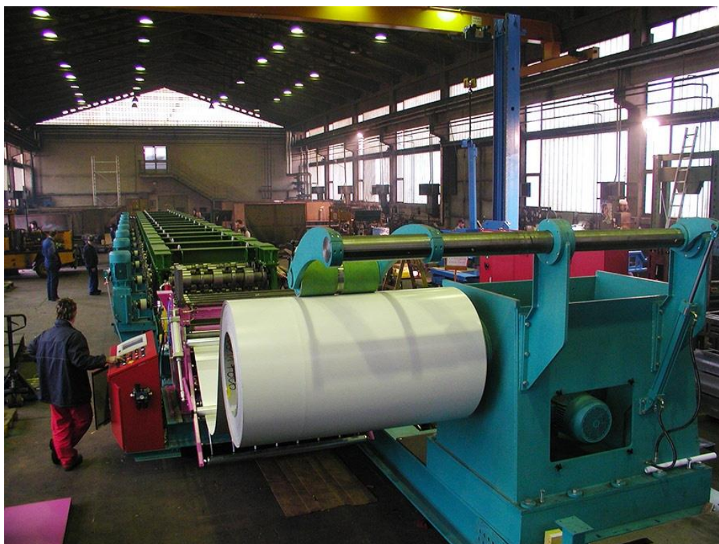
Slika 1.7 Stroj za profiliranje limova i traka [4]
