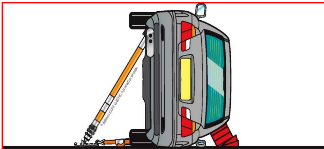
Slika 24. Stabilizacija vozila na boku.[1]
