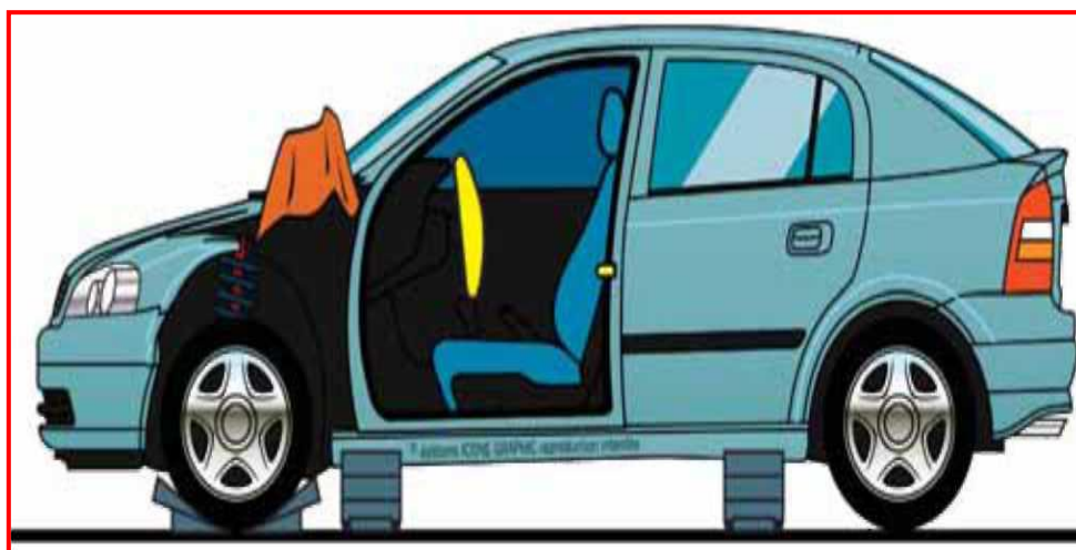
Slika 26. Uklanjanje vrata sa vozila.[1]
