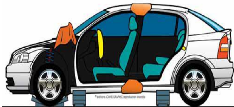
Slika 27. Uklanjanje stranice vozila.[1]
