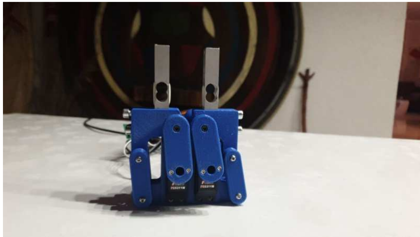
Slika 31: Sklopljena prihvatnica u zatvorenom položaju
