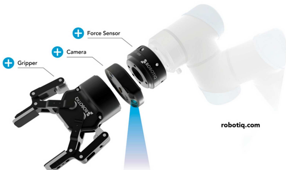
Slika 6: Robotska prihvatnica sa senzorima [16]
