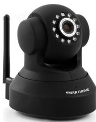
Slika 25. Bežična IP sigurnosna kamera
