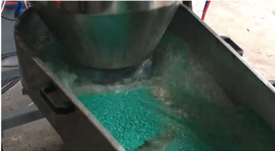
Slika 11. Pranje granulata komunalnog otpada 53
