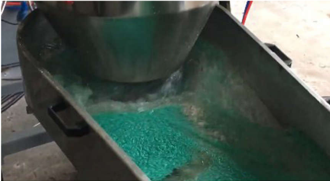
Slika 11. Pranje granulata komunalnog otpada 53
