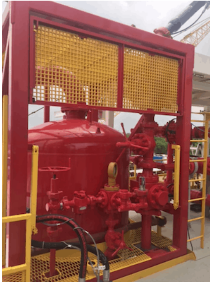
Slika 8. Prikaz manifold jedinice za stvaranje tlaka
