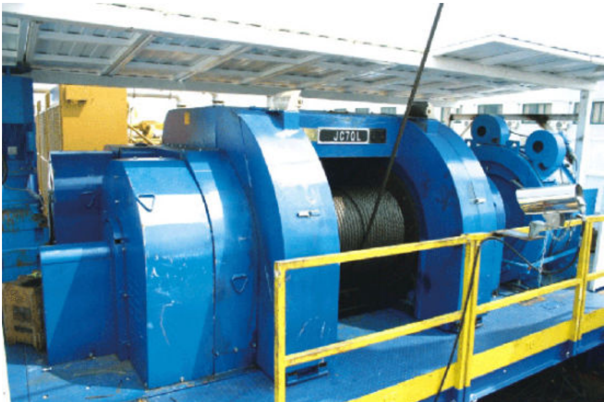
Slika 6. Primjer namotajnog bubnja ta podištu tornja
