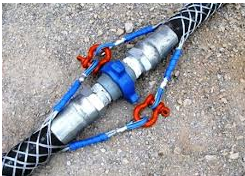
Slika 7. Whip arrestori za visokotlačne vodove
