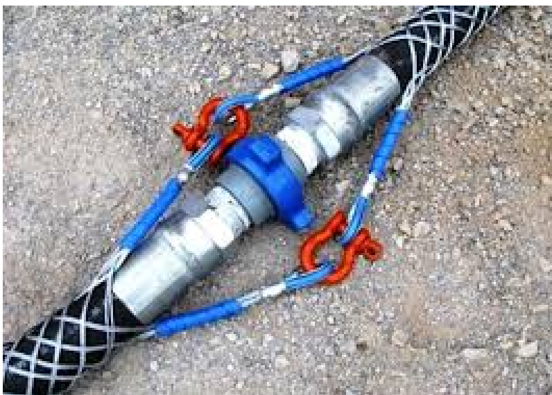
Slika 7. Whip arrestori za visokotlačne vodove
