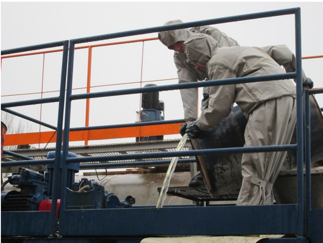
Slika 10. Dodavanje kemikalije u isplaku na bušačem postrojenju
