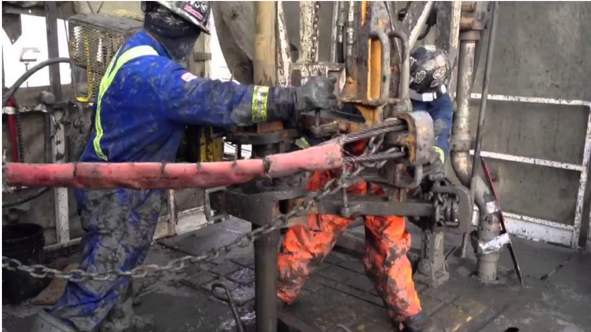
Slika 41. Dvoje radnika prilikom spajanja bušačkih šipki na radnom podištu
