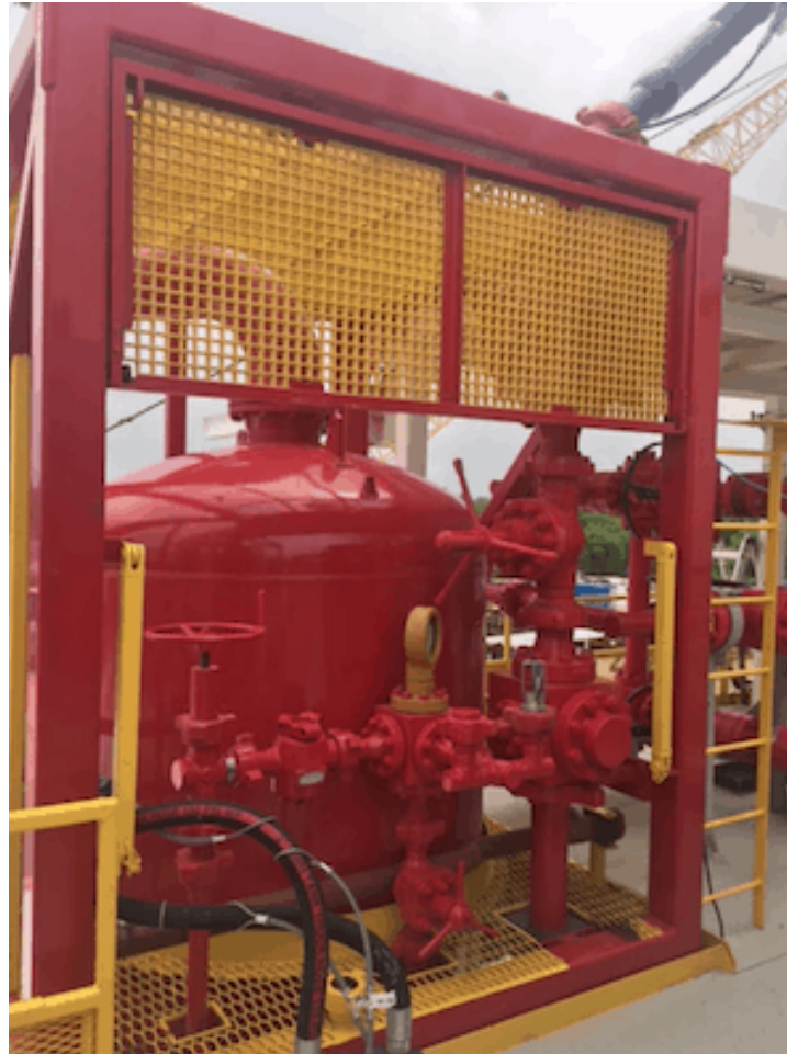
Slika 8. Prikaz manifold jedinice za stvaranje tlaka
