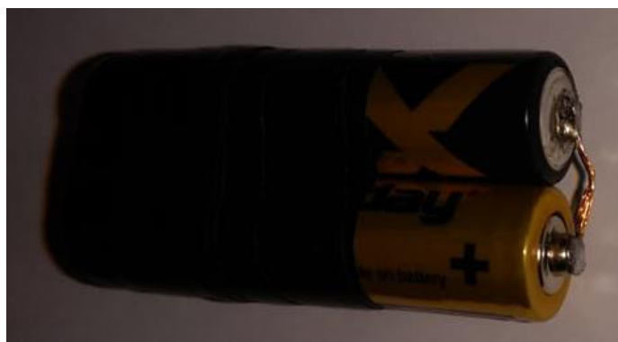
Slika 45. Prikaz zalemljenih i spojenih žicom AAA baterija
