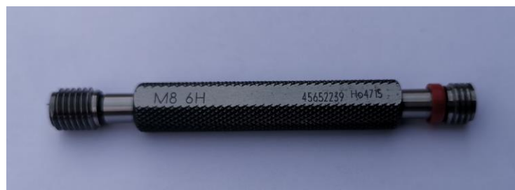
Slika 31. Kontrolni kalibar za M8
