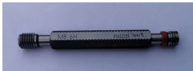
Slika 31. Kontrolni kalibar za M8
