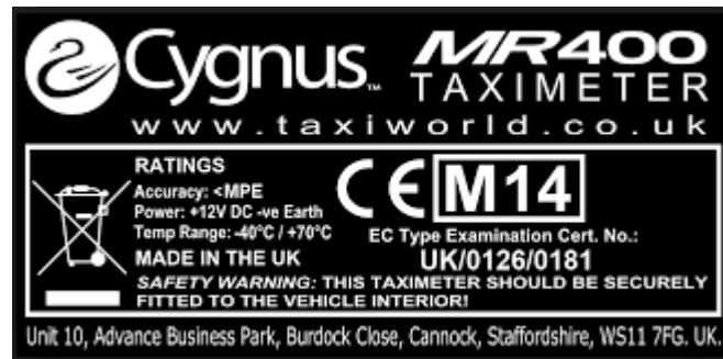
Slika 5. Prikaz dodatne mjeriteljske oznake na primjeru taksimetra.
