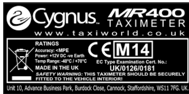
Slika 5. Prikaz dodatne mjeriteljske oznake na primjeru taksimetra.
