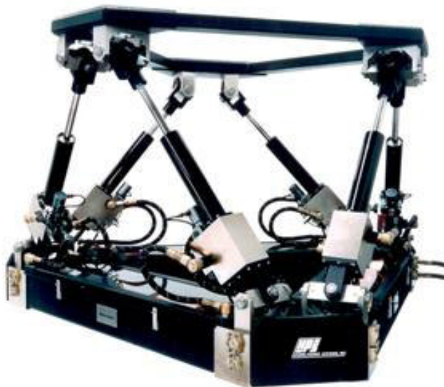
Slika 2-6. Primjer paralelnog manipulatora sa 6-DOF
