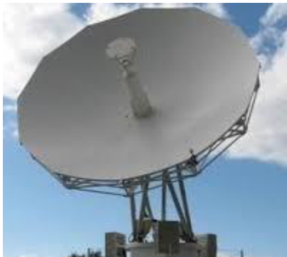
Slika 2-12. Hexapod za pozicioniranje antene
