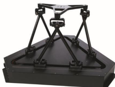
Slika 2-18. Verzija s konstantnom duljinom krakova
