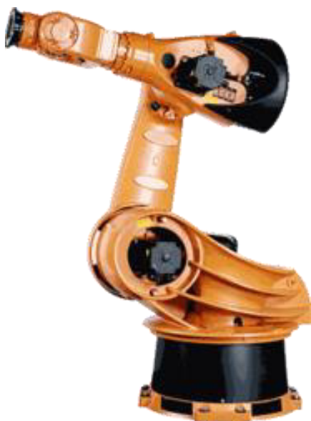
Slika 2-5. Primjer serijskog manipulatora
