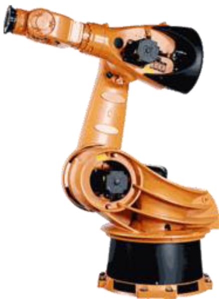
Slika 2-5. Primjer serijskog manipulatora
