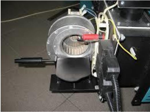
Slika 16. Radijalni ventilator [19]
