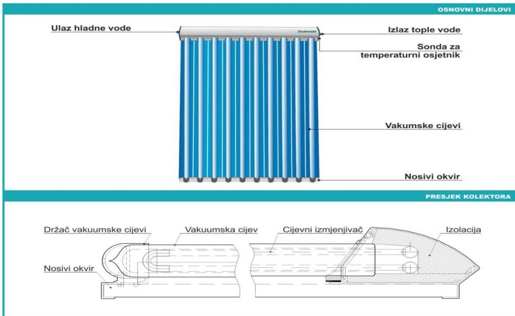
Slika 36. Elementi i presjek kolektora [43]
