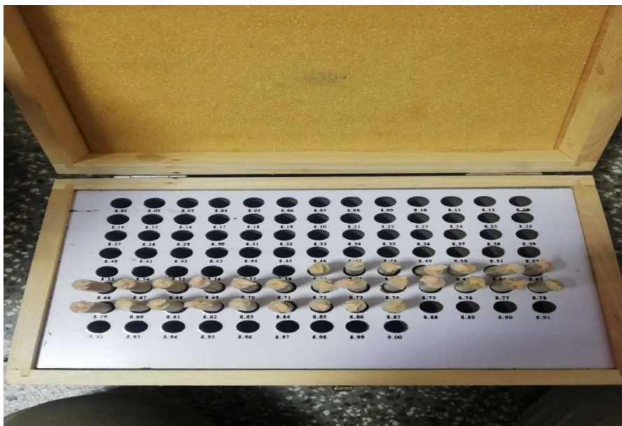
Slika 14. Razvrstavanja kalibara za provrte
