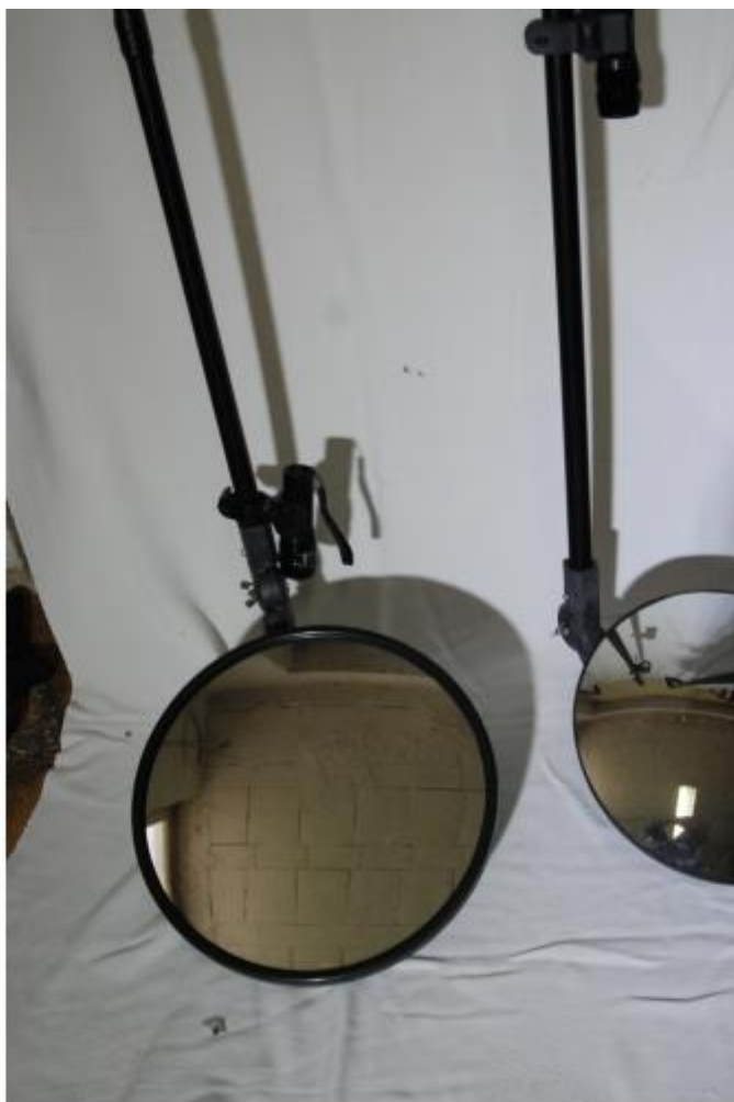
Slika 7. – Predodžba - Ručno ogledalo za pregled vozila (12)
