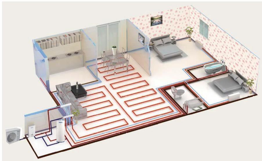
Slika 5. Primjer sustava s dizalicom topline zrak-voda [5]
