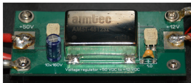
Slika 34. 12V modul Aimtec AM5T-4812SZ
