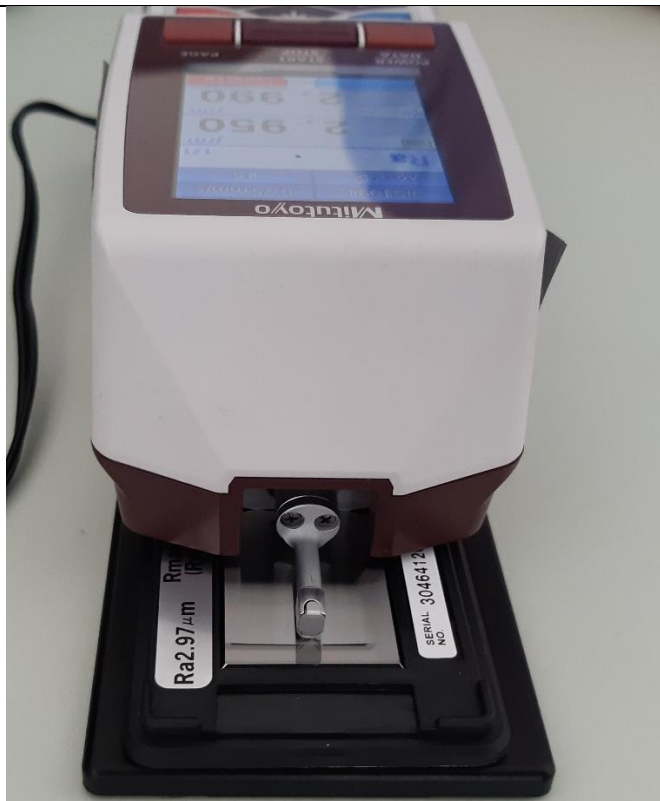
Slika 25. Prikaz kalibriranja pomoću etalona
