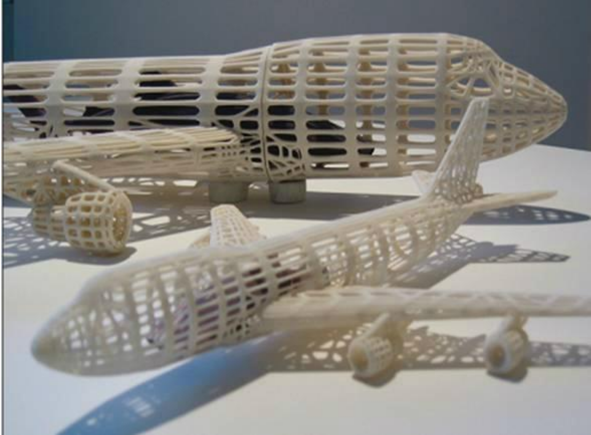
Slika 19. Primjer proizvoda SLS postupka [18]
