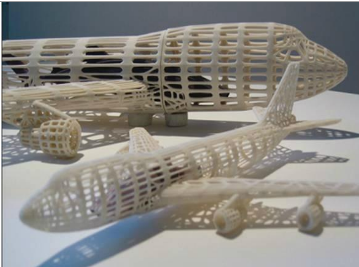
Slika 19. Primjer proizvoda SLS postupka [18]
