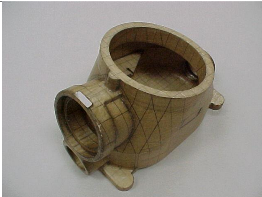
Slika 12. Primjer proizvoda načinjenog LOM postupkom [11]
