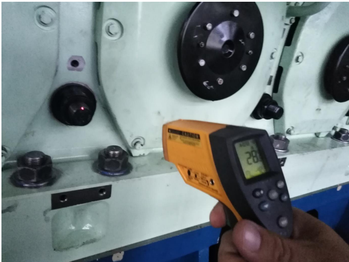
Slika 36. Predodžba mjerenja temperature temeljnih ležajeva tijekom ispitivanja **
