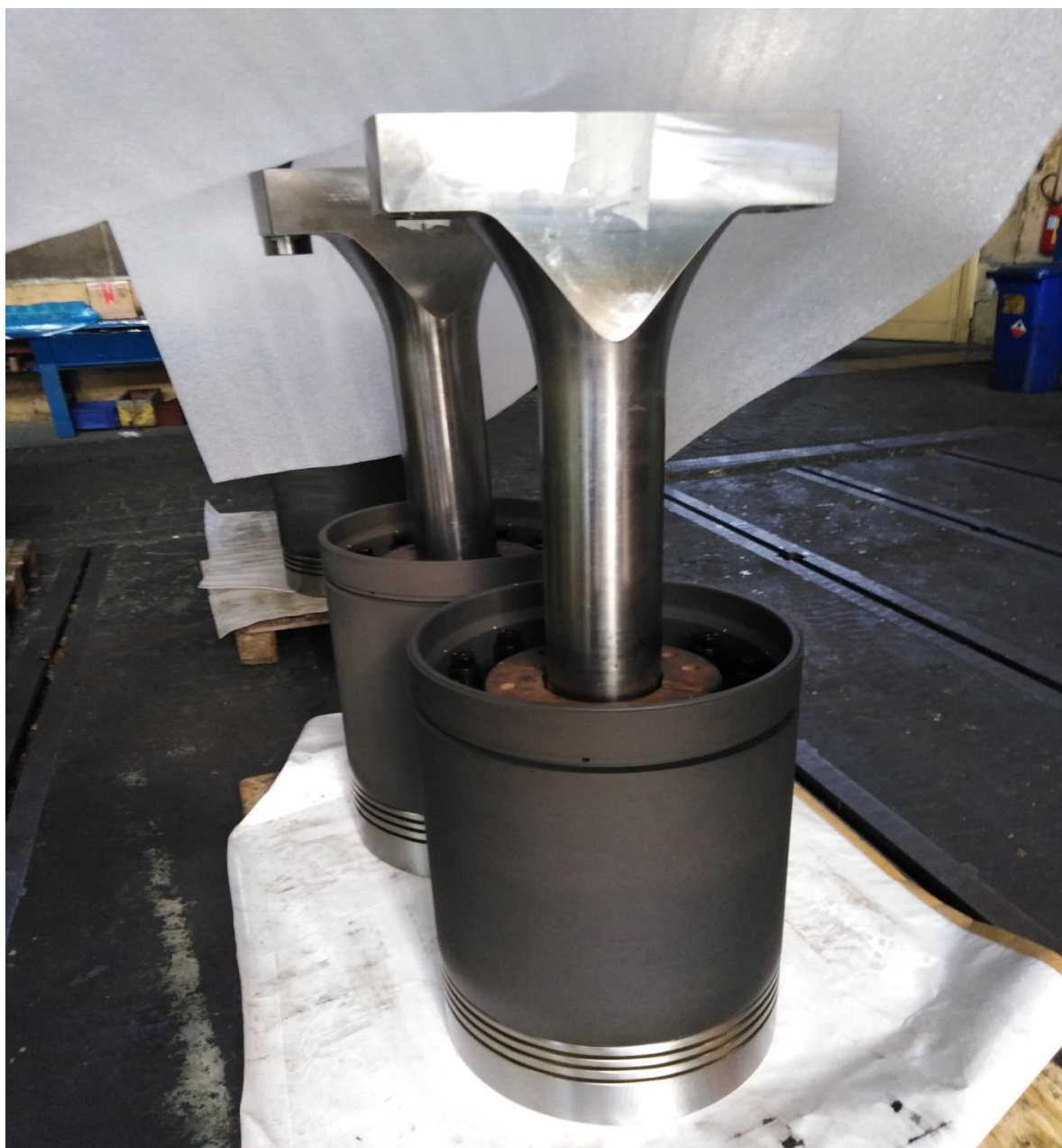
Slika 17. Predodžba složenog klipnog mehanizma prije montaže u motor
