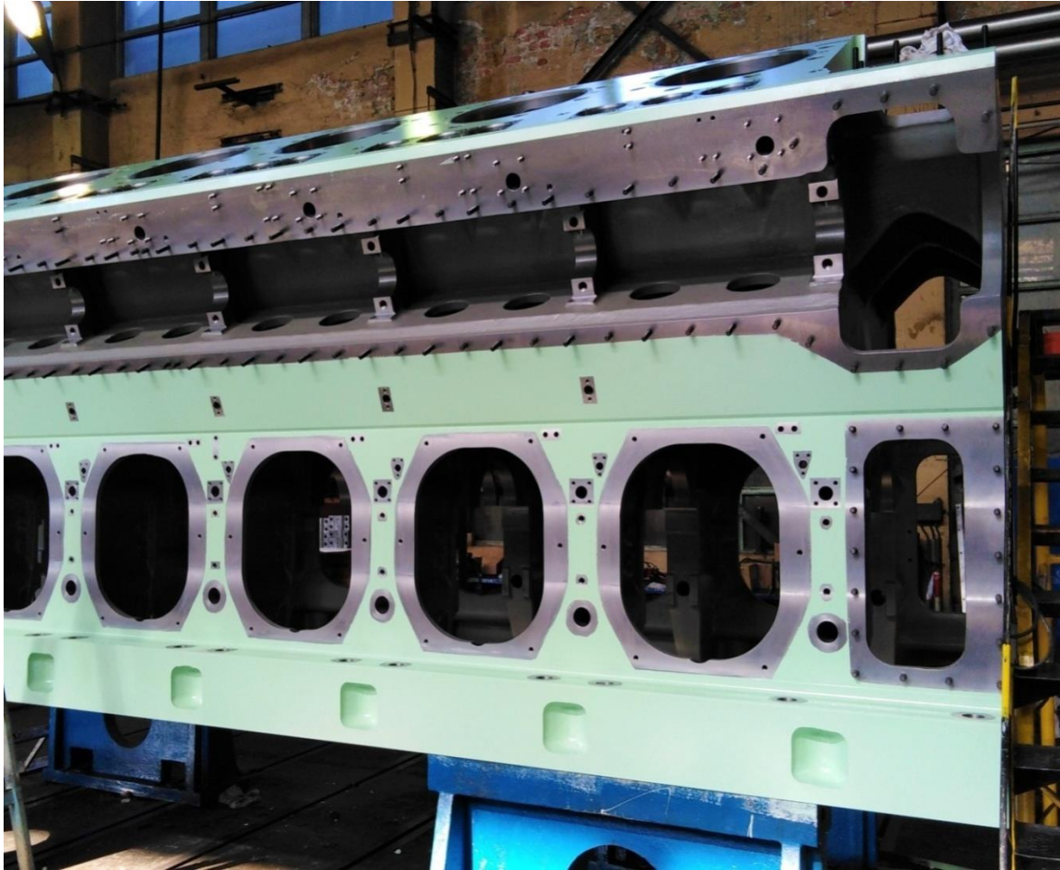
Slika 09. Predodžba kućišta motora ADRIA 40 prije montaže dijelova **
