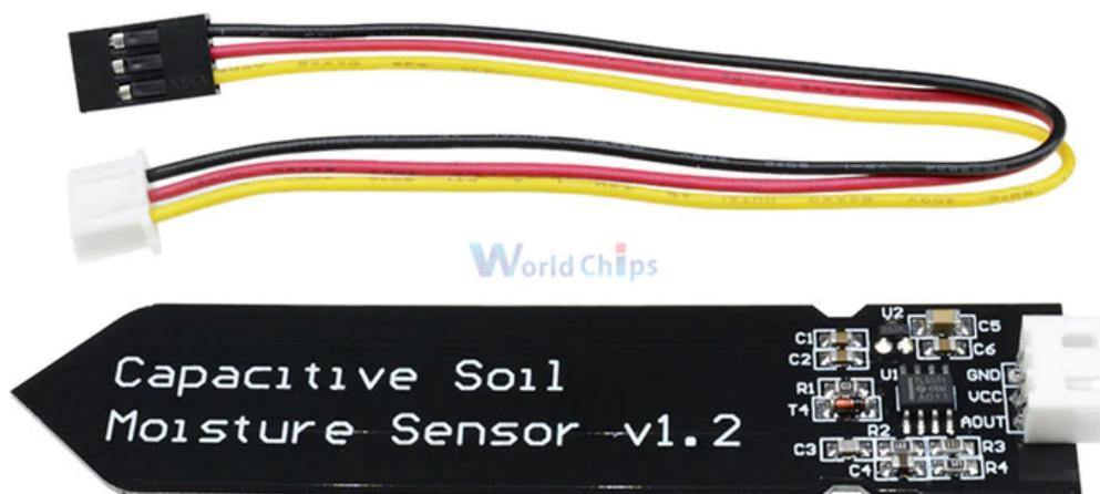
**Slika 19. Predodžba kapacitivnog senzora vlažnosti tla. [16]**
