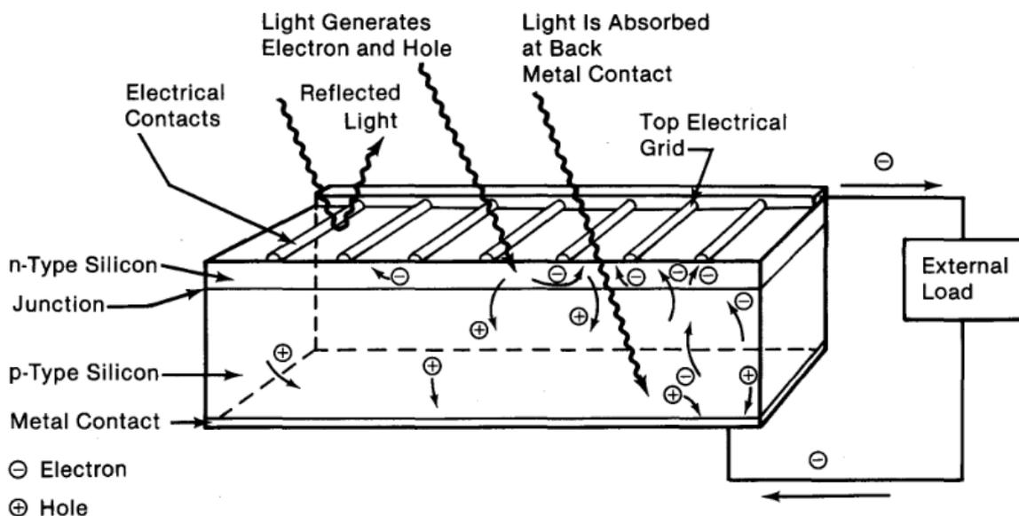
**Slika 11. Predodžba kreiranja elektron-šupljina para, njihovo odvajanje potencijalnom barijerom i kreiranje napona koji tjera struju kroz krug [11]**
