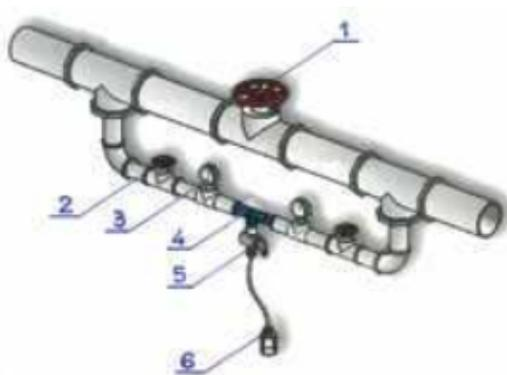
**Slika 1. Predodžba injektora na bazi Venturijeve cijevi. [3]**
