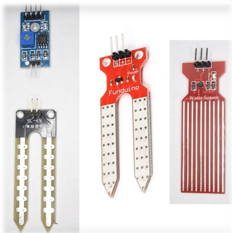
**Slika 16. Predodžba različitih otporničkih senzora vlažnosti tla. [16]**
