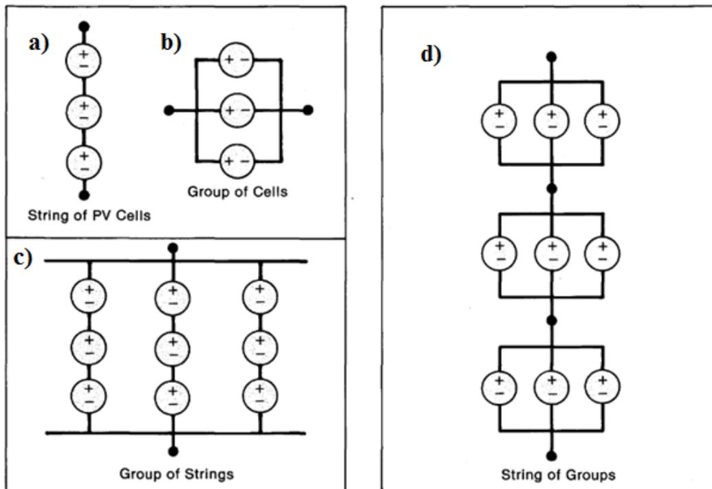
**Slika 12. Predodžba povećanja naponskog izlaza u serijskom spoju (a); strujnog izlaza u paralelnim spajanjem (b); kombinirani spojevi (c) i (d) povećavaju i napon i struju; kod svih spojeva paziti na polaritete. [11]**
