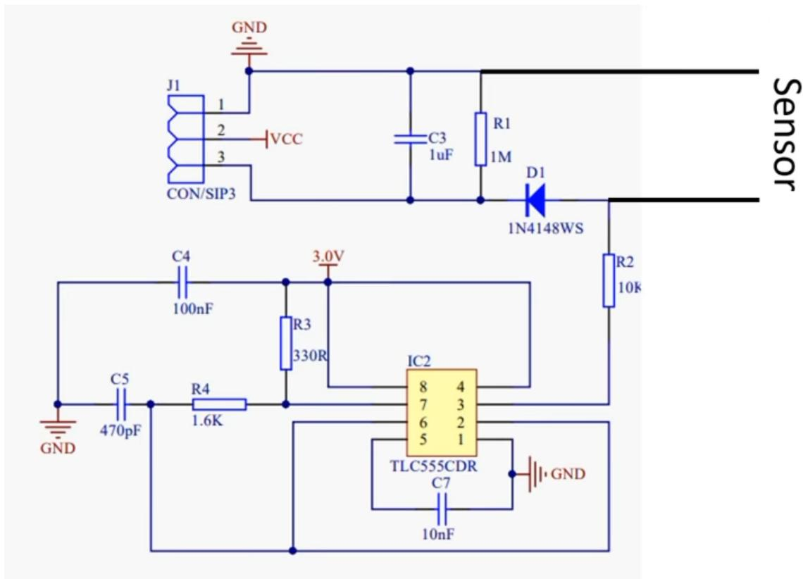
Slika 20. Predodžba sheme kapacitivnog senzora vlažnosti tla. [16]
