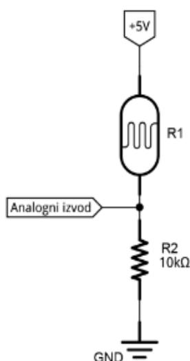
**Slika 23. Predodžba fotootpornika u spoju naponskog djelila. [22]**
