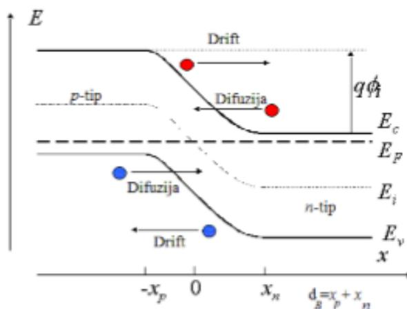
**Slika 10. Predodžba p-n spoja u termalnoj ravnoteži, izjednačenje Fermijeve energije – ravnotežni spoj. [10]**
