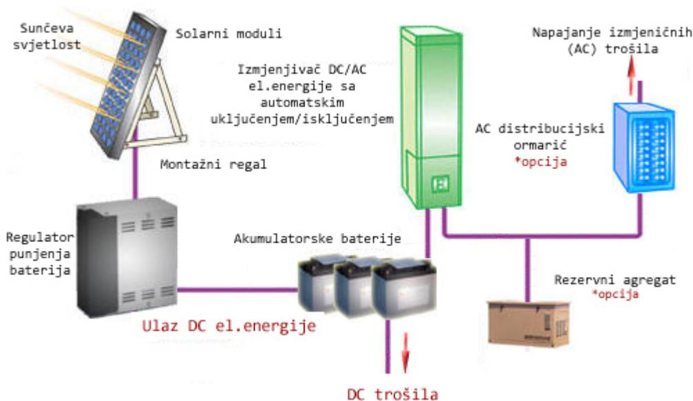
**Slika 13. Predodžba prikaza samostalnog fotonaponskog sustava [12]**
