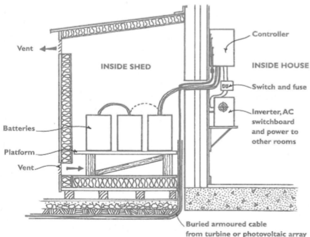
**Slika 14. Predodžba pohrane baterija u posebno izgrađenoj šupi. [13]**
