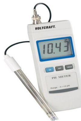
Slika 3. pH metar (lat. potentiahydrogenii : snaga vodika)
