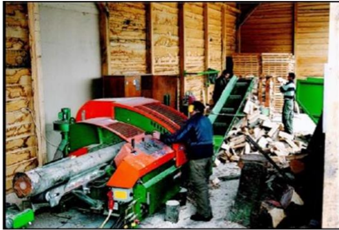
Slika 22 - Suvremeni stroj za cijepanje ogrijeva
