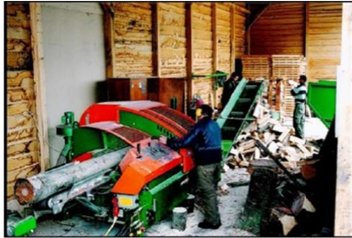
Slika 22 - Suvremeni stroj za cijepanje ogrijeva
