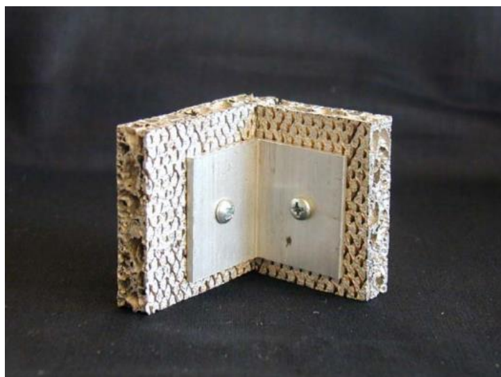
Slika 40. Rastavljivo spajanje metalnih pjena [10]
