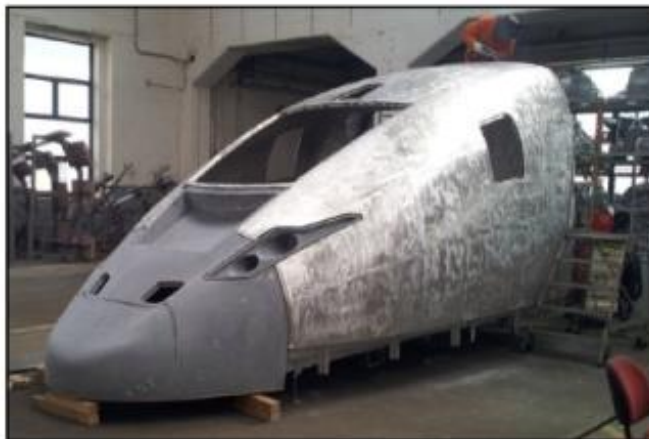
Slika 47. Prototip njemačkog vlaka izrađenog od Al pjene zavarene sendvič konstrukcije [13]
