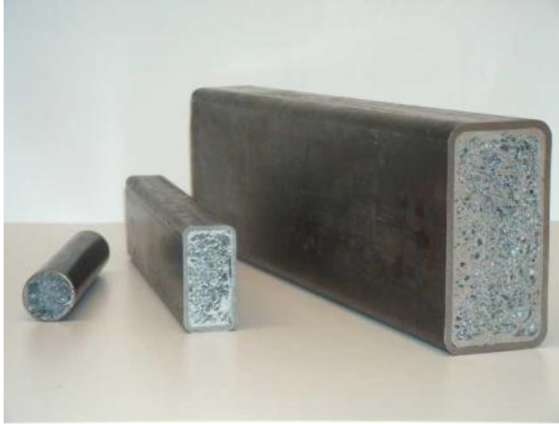
Slika 36. Sendvič-konstrukcija s jezgrom od metalne pjene [11]
