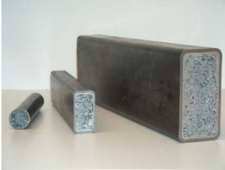
Slika 36. Sendvič-konstrukcija s jezgrom od metalne pjene [11]
