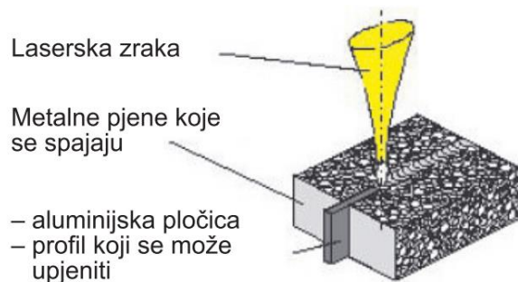
Slika 41. Lasersko zavarivanje metalne pjene [1]
