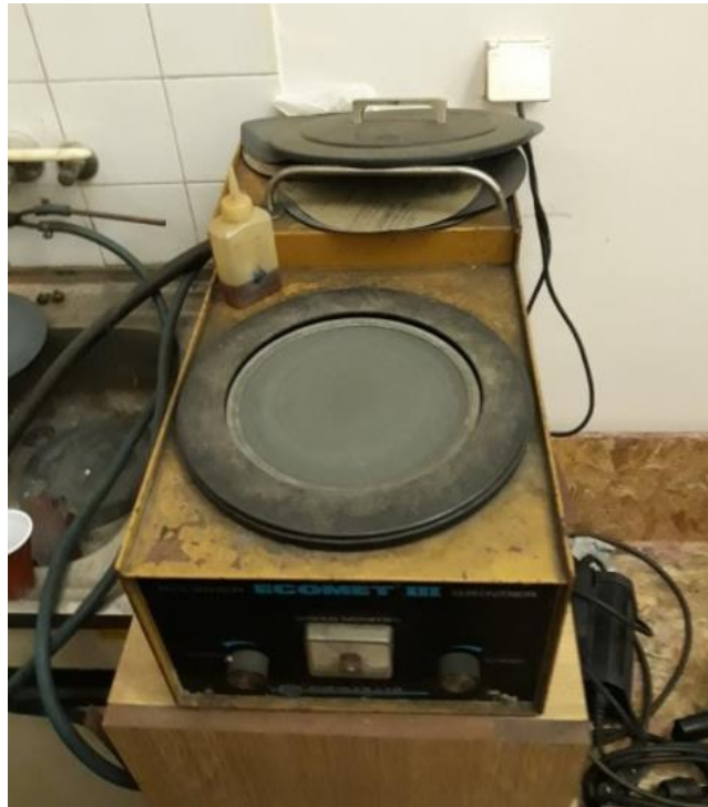
Slika 26. Polirka Buehler Ecomet 3 [10]
