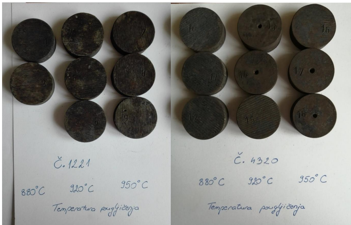
Slika 23. Uzorci Č.1221 i Č.4320 nakon postupka cementacije [10]
