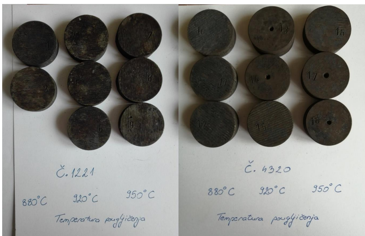
Slika 23. Uzorci Č.1221 i Č.4320 nakon postupka cementacije [10]
