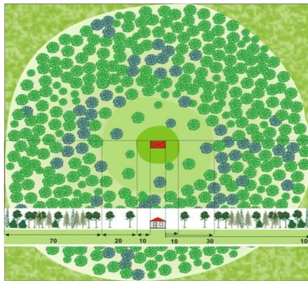
Slika 5 – Tri koncentrične zone prioriteta oko zgrade [17]
