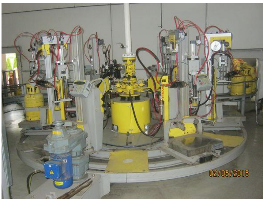
Slika 43. Karusel u punionici boca
