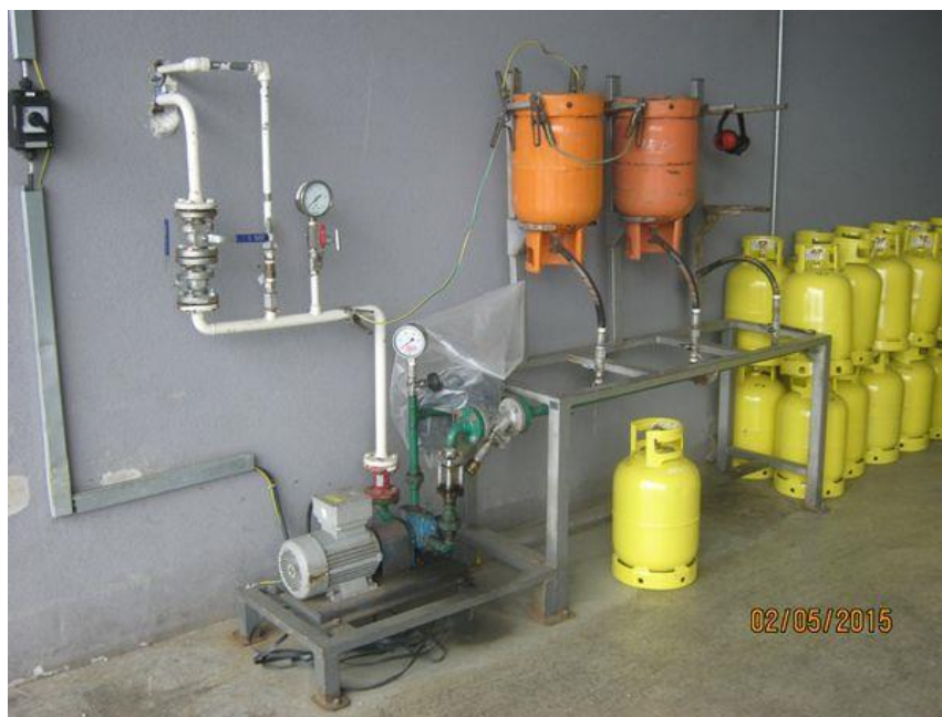
Slika 47. Uređaj za pražnjenje neispravnih boca
