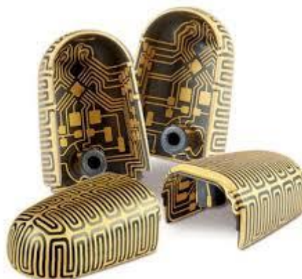
Slika 14. Primjer predmeta izrađenih MID tehnologijom
