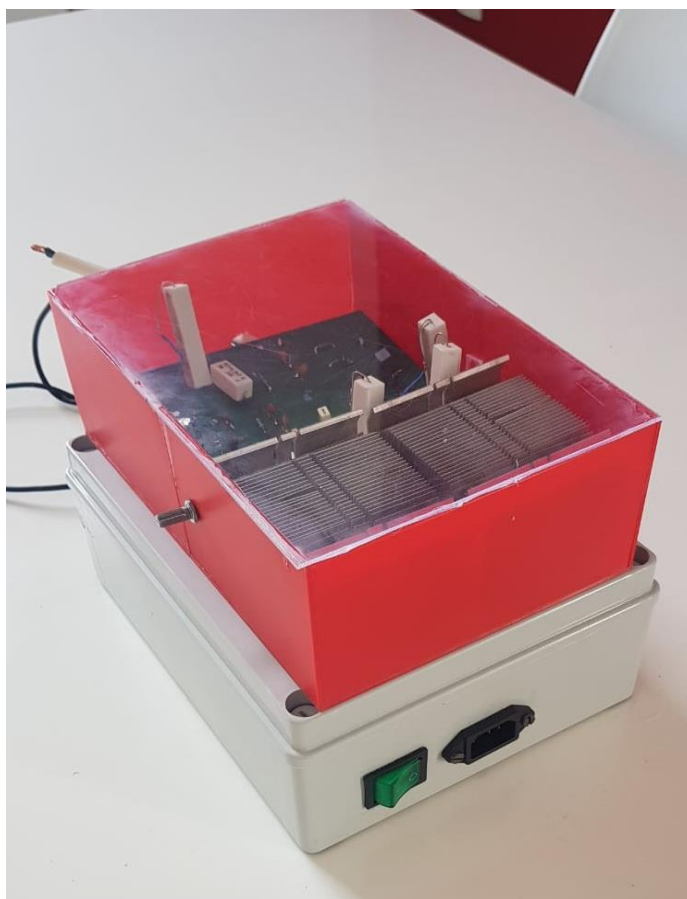
Slika 1 Izgled izrađenog pojačala
