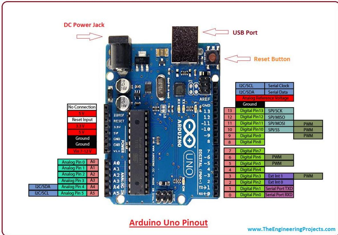
Slika 17: Popis pinova Arduino Uno upravljačke jedinice [7].
