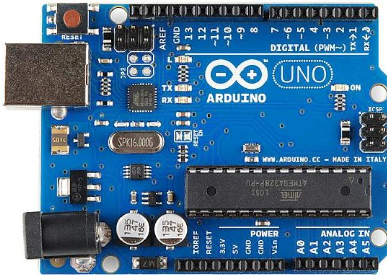
Slika 16: Arduino Uno upravljačka jedinica.
