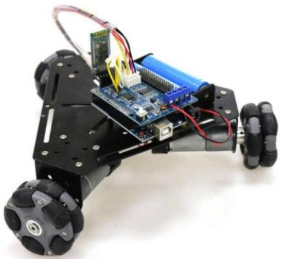
Slika 3: Izvedba svesmjernog robota s tri kotača.
