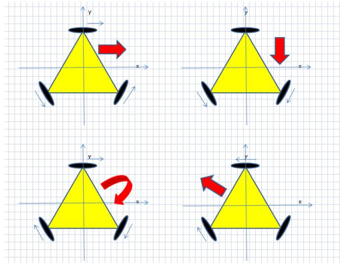
Slika 8: Shematski prikaz gibanja svesmijernog robota s tri omni kotača [4].
