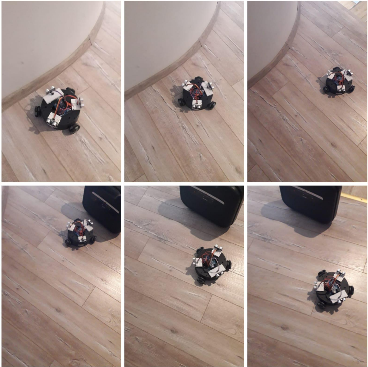
Slika 32: Primjeri izbjegavanja prepreka svesmjernog robota
