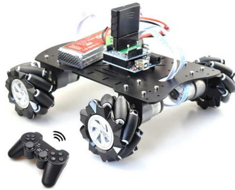
Slika 4: Izvedba svemjernog robota sa četiri kotača.
