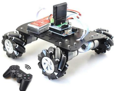
Slika 4: Izvedba svesmjernog robota sa četiri kotača.
