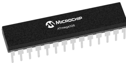
Slika 18: ATmega 328 mikrokontroler.
