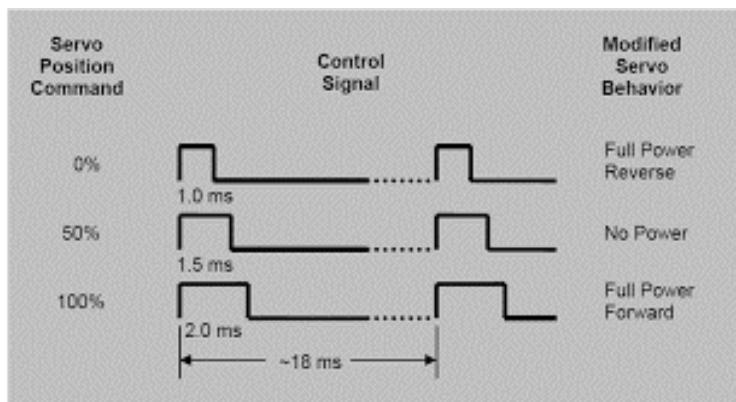
Slika 15: Kontrola servo motora pomoću PWM signala [5].
