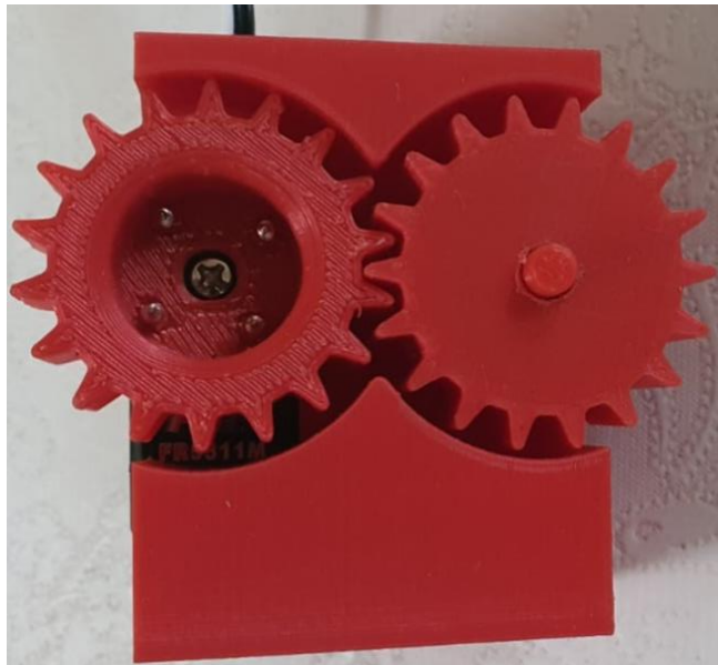
Slika 25: Zupčani par i nosač vilica
