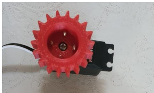
Slika 21: Pogonski zupčanik montiran na servo motor
