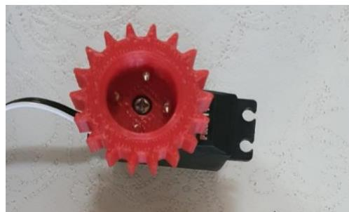
Slika 21: Pogonski zupčanik montiran na servo motor
