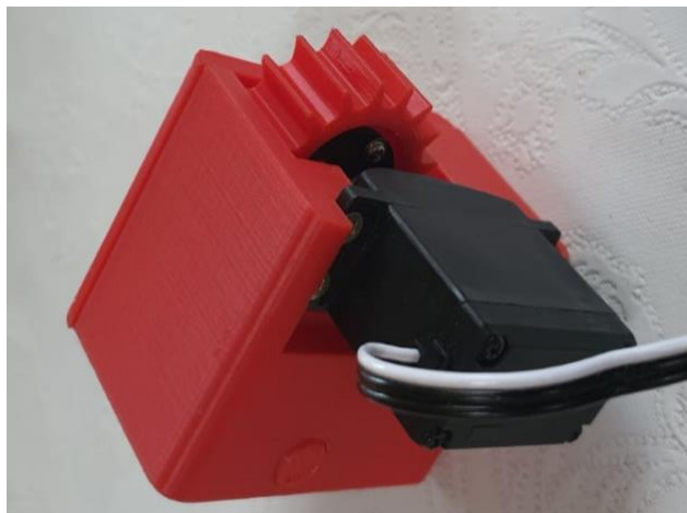
Slika 27: Sastavljen nosač vilica stražnja strana
