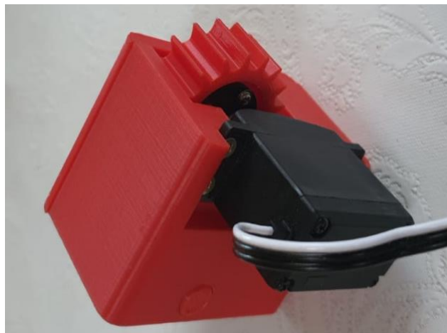
Slika 27: Sastavljen nosač vilica stražnja strana
