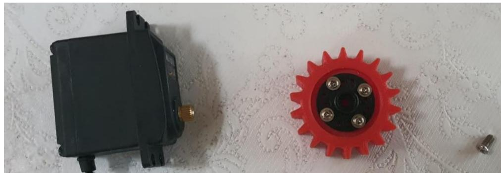
Slika 20: Prirubnica montirana na pogonski zupčanik
