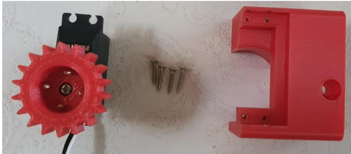
*Slika 22: Motor, vijci i nosač vilica*
