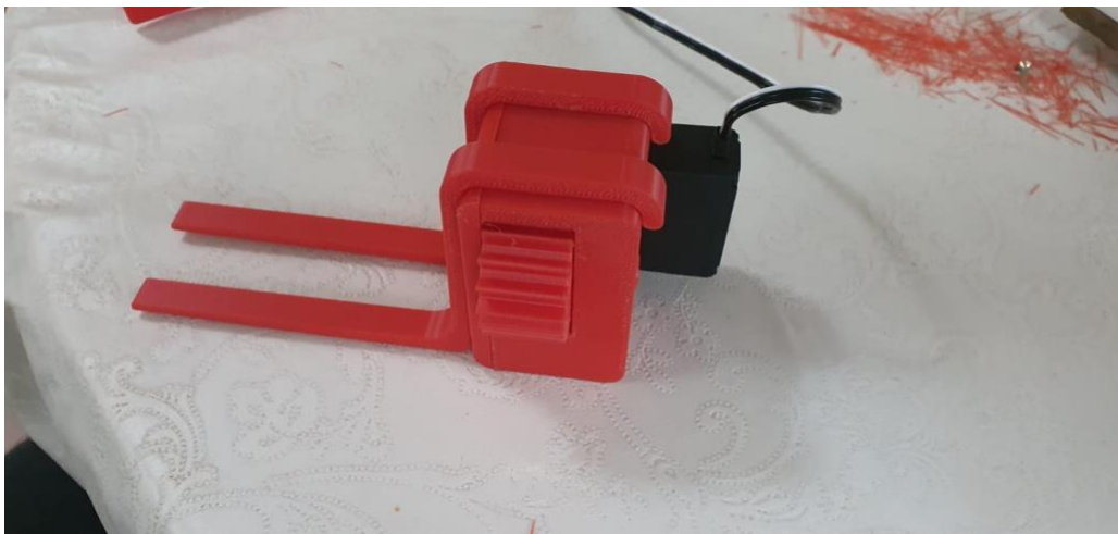
Slika 37: Sastavljen nosač i vilice
