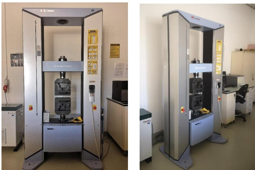
Slika 40. Kidalica Shimadzu AG-x plus
