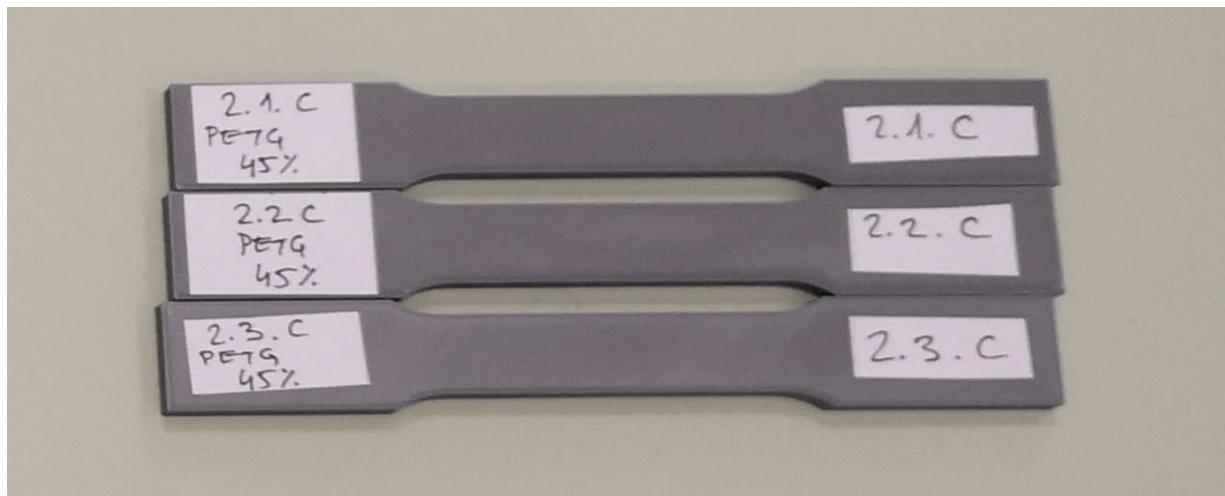
Slika 39. Primjer označavanja epruveta
