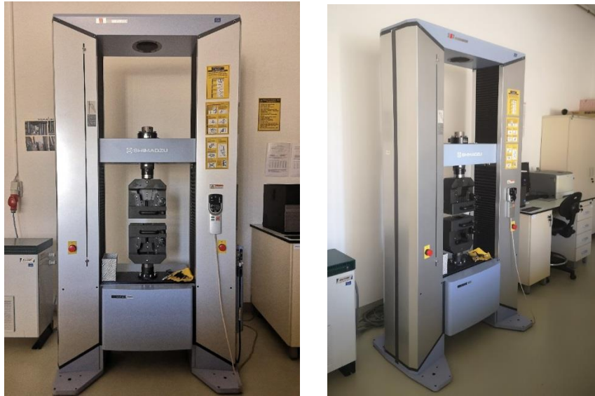
Slika 40. Kidalica Shimadzu AG-x plus
