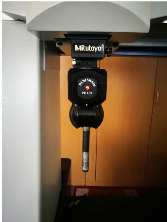
Slika 29. Renishaw PH10T mjerna sonda
