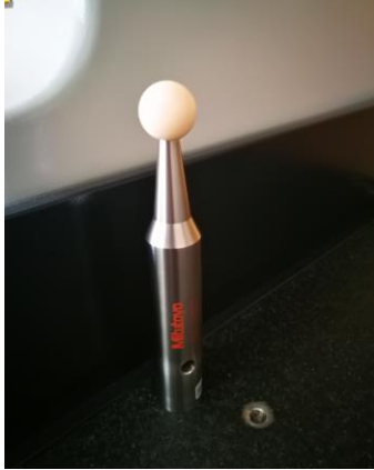
Slika 31. Kugla za umjeravanje
