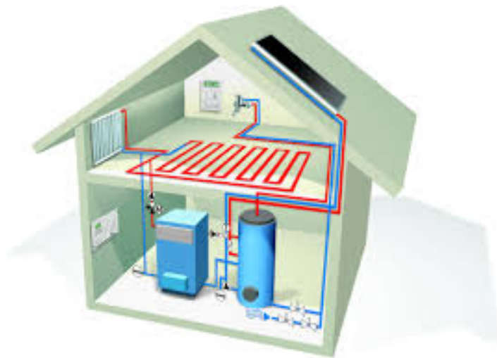
Slika 9. Kombinacija radijatorskog i podnog toplovnog centralnog grijanja
