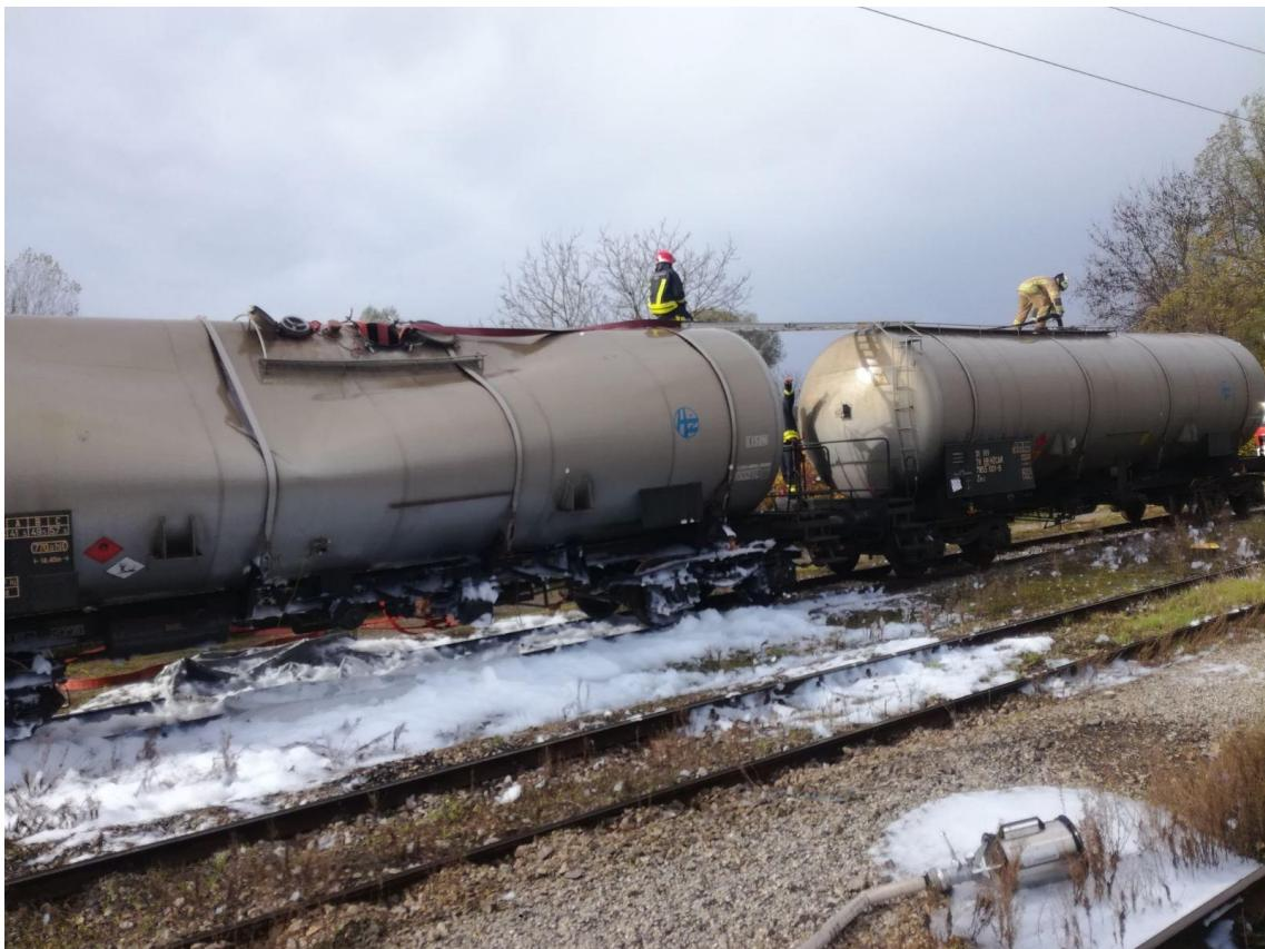
**Slika 17.** Prepumpavanje zapaljive tekućine.[10]
