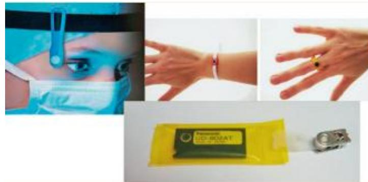
Sl. 10. Termoluminiscentni dozimetri za mjerjenje izloženosti očne leće, šake ili kože te cijelog tijela
