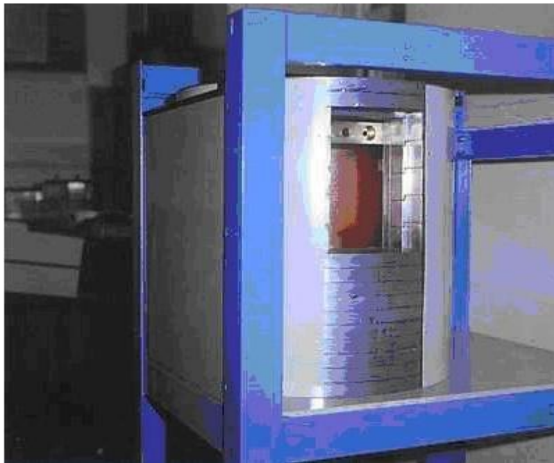
Sl. 13. Primjer masivnog olovnog štita za potrebe nuklearnog laboratorija
